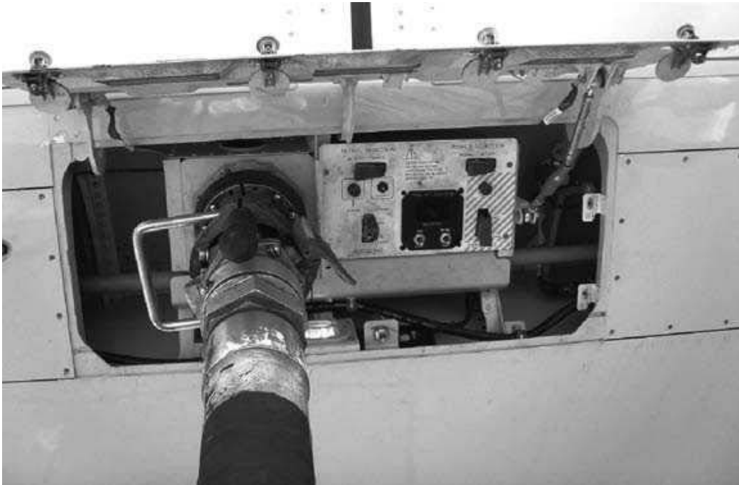
Slika 5.6 Stanica za punjenje goriva na zrakoplovu Embraer 190 [14]
