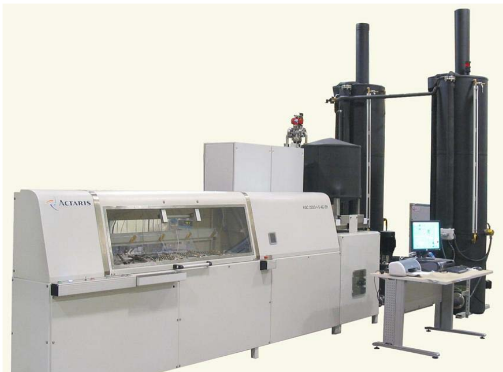
Slika 7.1 Automatska mjerna linija ACTARIS RAC 2200/1/5-AG-EH
