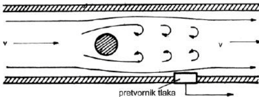
Slika 1.8 Vortex protokomjer [4]
