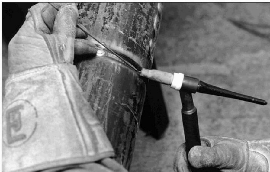
Slika 7. Ručno TIG zavarivanje [4]
