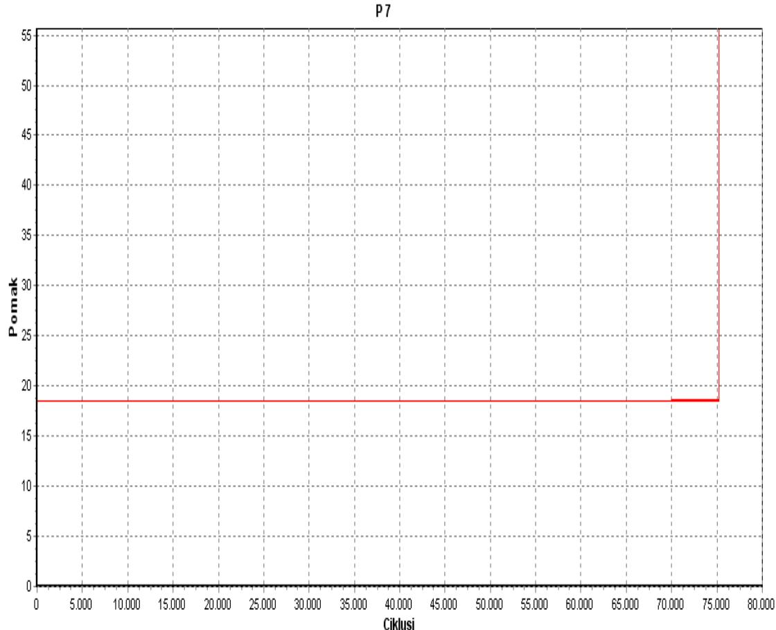
Slika 6.10 Pomak-ciklus za poliranu epruvetu P 7
