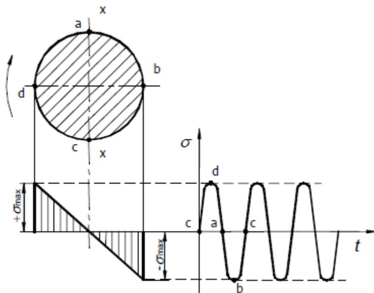
Slika 3.1 *Naizmjenično promjenjivi ciklus normalnog naprezanja pri statickom savijanju rotirajuće osovine*
