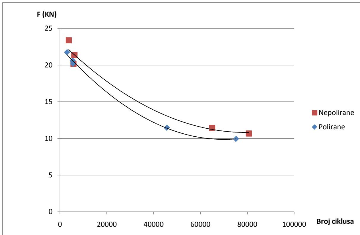
Slika 6.11 Wöhler-ova krivulja za nepolirane i polirane epruvete
