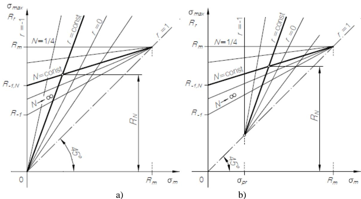
Slika 4.5 Određivanje dinamičke čvrstoće za ograničenu trajnost  $N$  materijala izloženog cikličkim naprezanjima s koeficijentom asimetrije ciklusa  $r$ , a) u odsustvu statickog prednaprezanja b) uz staticko prednaprezanje  $\sigma_{pr}$
