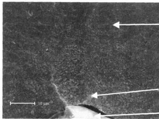
Slika 2.1 *Tvrda uključina kao izvor ispod površinskog začeća pukotine Cr-Mo čelika*
