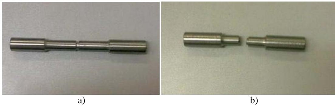
Slika 6.4 Nepolirana epruveta a) prije ispitivanja, b) nakon ispitivanja
