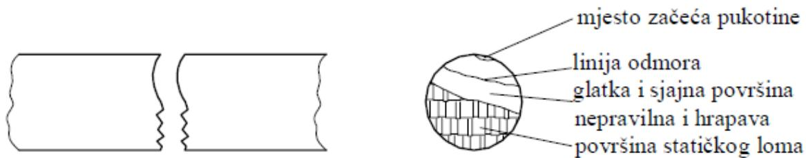
Slika 2.3 Opći izgled površine loma uslijed zamora materijala
