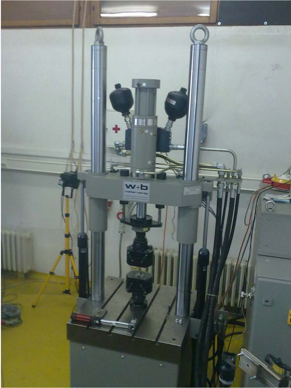
Slika 6.1 Servohidraulička umaralica LFV-50 HH
