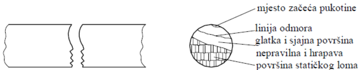
Slika 2.3 Opći izgled površine loma uslijed zamora materijala
