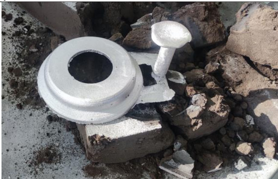
Slika 69. Vađenje odljevka iz kalupa
