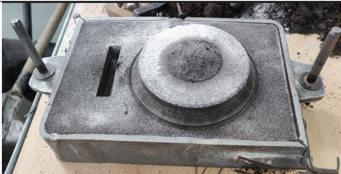
Slika 59. Vađenje modela razvodnika
