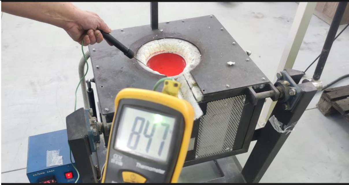
Slika 63. Mjerenje temperature taline
