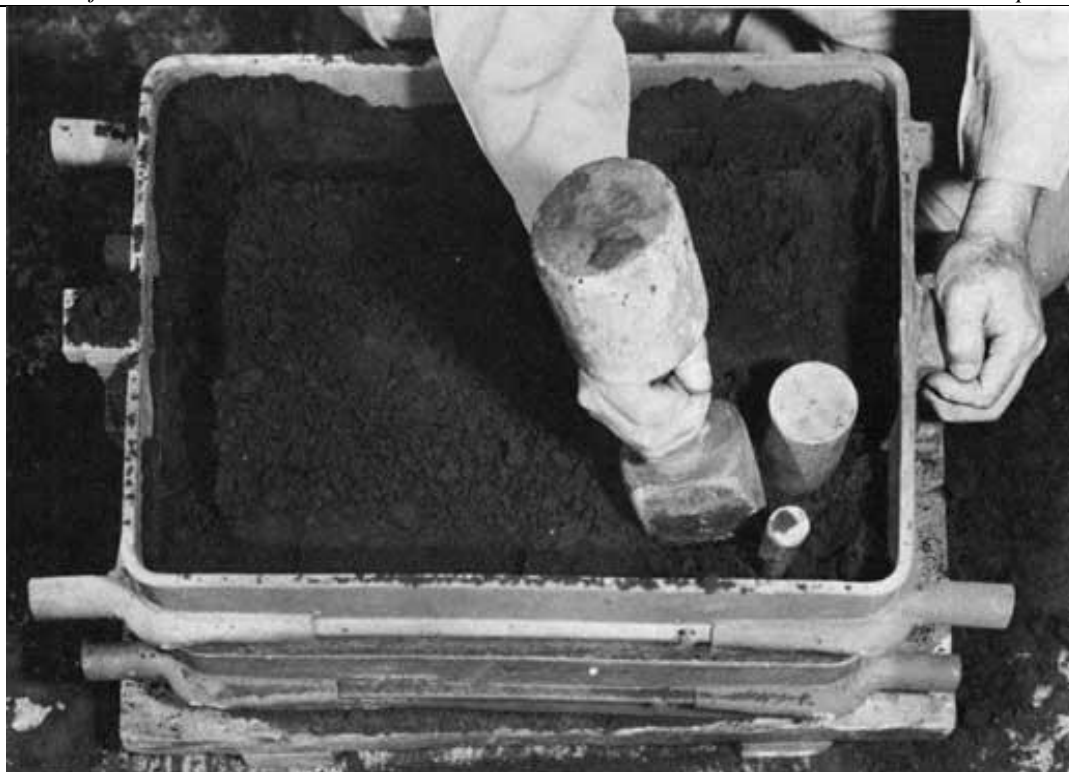
Slika 6. Ručno punjenje i sabijanje kalupa [13]
