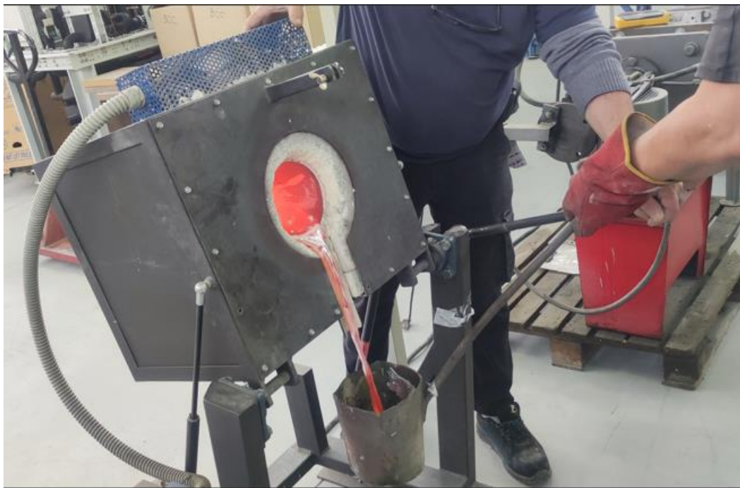
Slika 64. Ulijevanje u ljevački lonac
