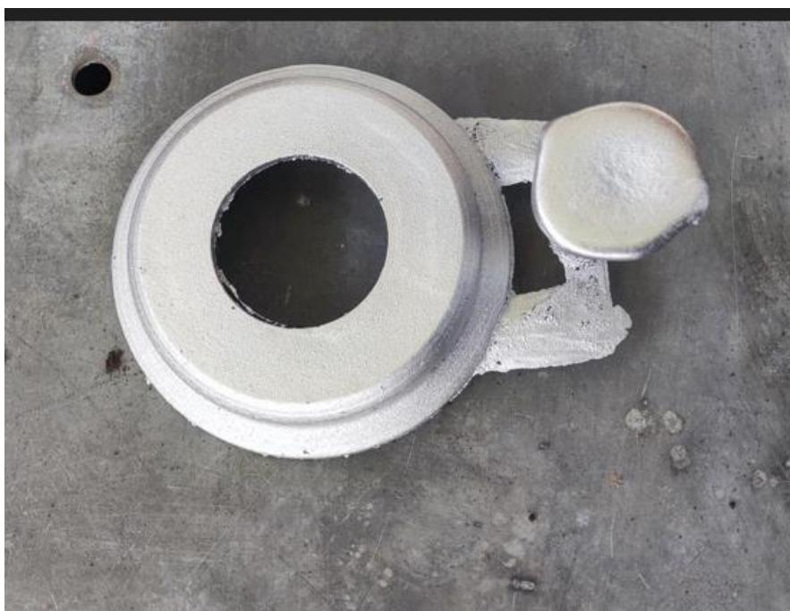
**Slika 70. Odljevak s uljevnim sustavom**
