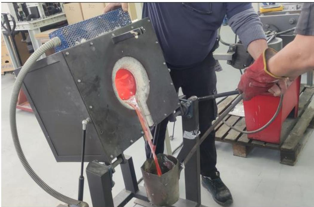
Slika 64. Ulijevanje u ljevački lonac
