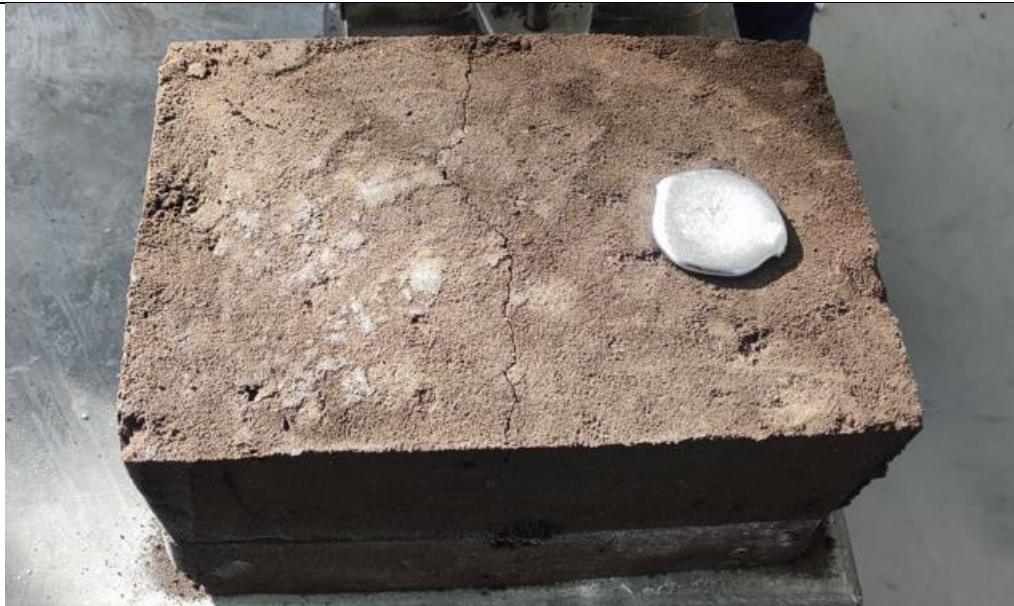
**Slika 67. Izgled kalupa nakon skrućivanja**
