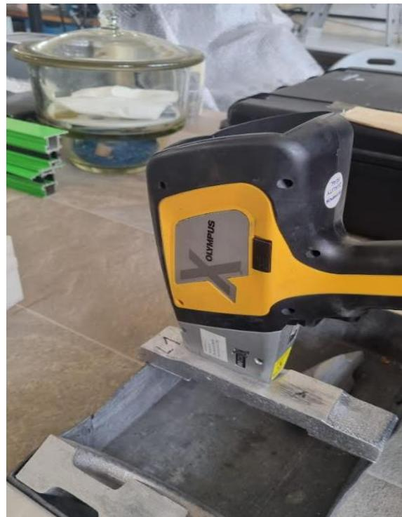
**Slika 73. Određivanje kemijskog sastava odljevka XRF metodom**
