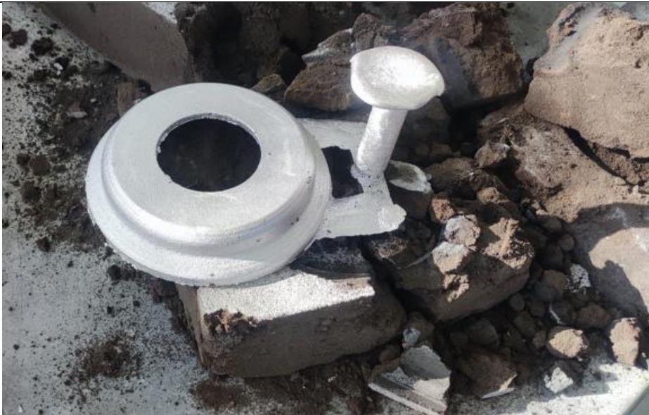
**Slika 69. Vađenje odljevka iz kalupa**
