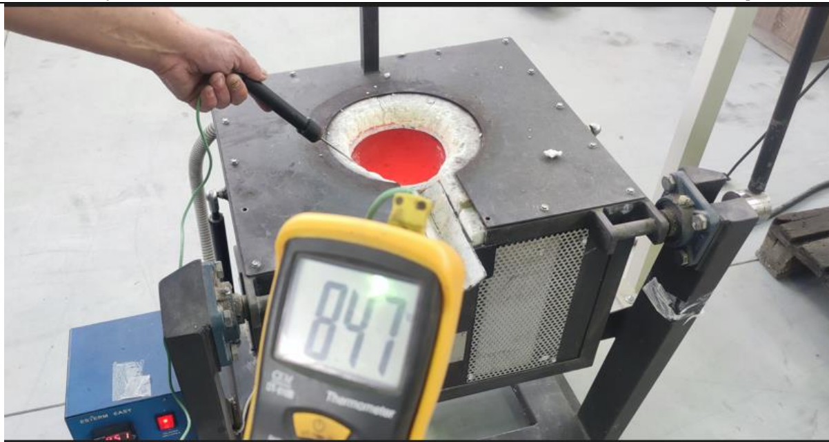
Slika 63. Mjerenje temperature taline
