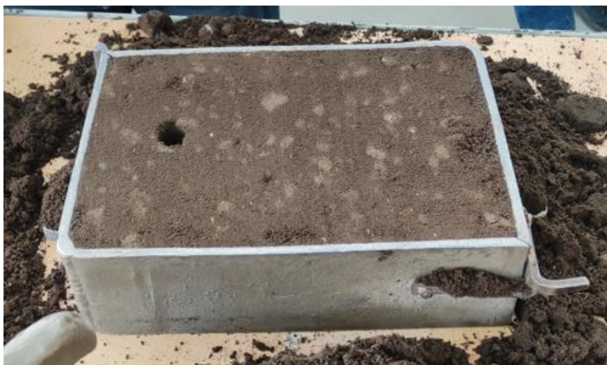
Slika 55. Poravnavanje kalupne mješavine u gornjaku
