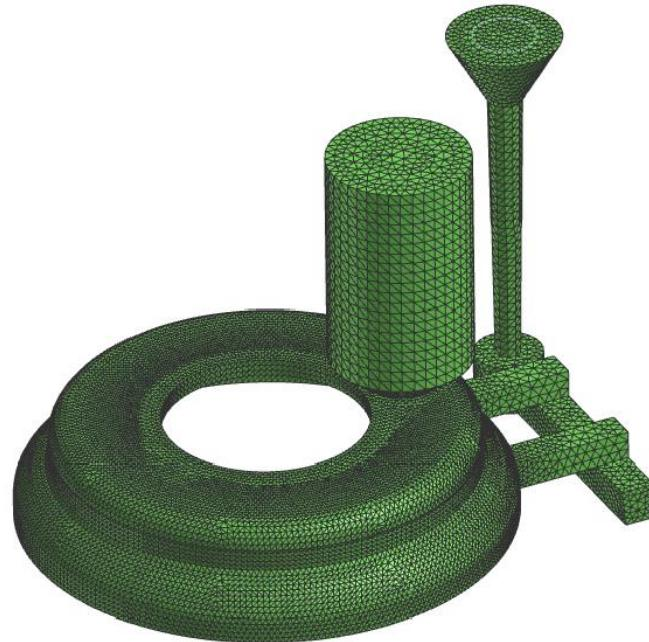
**Slika 37. Mreža odljevka, uljevnog sustava i pojila**
