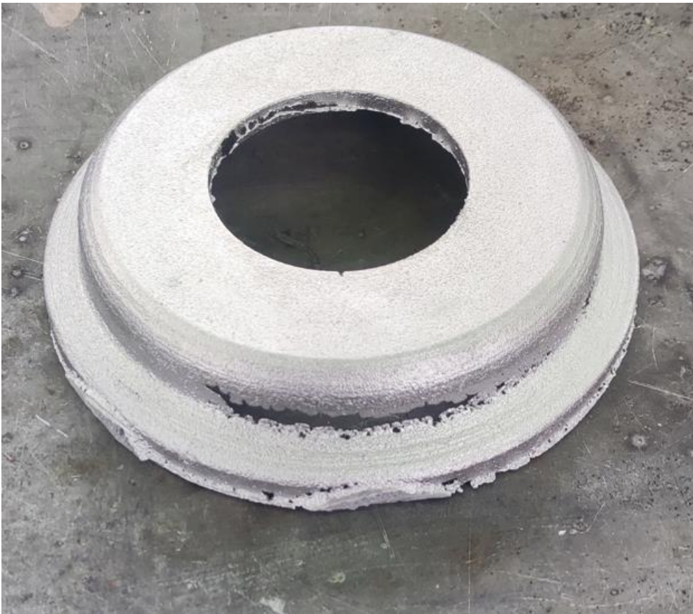
Slika 71. Greška u odljevku
