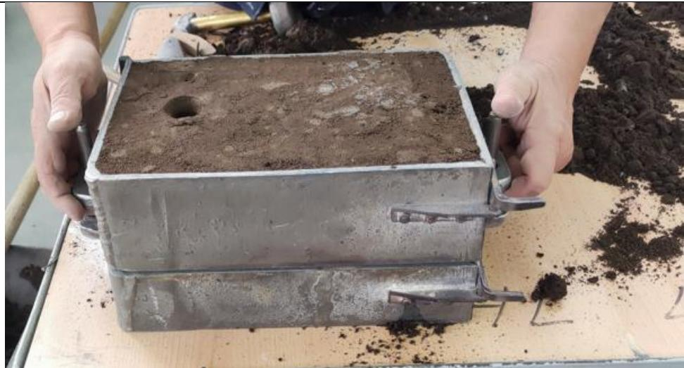
Slika 61. Zatvaranje kalupa
