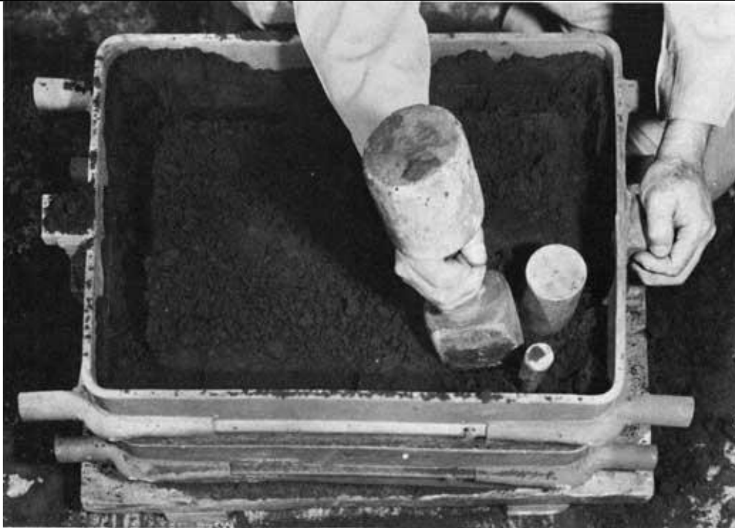
Slika 6. Ručno punjenje i sabijanje kalupa [13]
