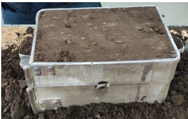
Slika 58. Poravnavanje kalupne mješavine u donjaku
