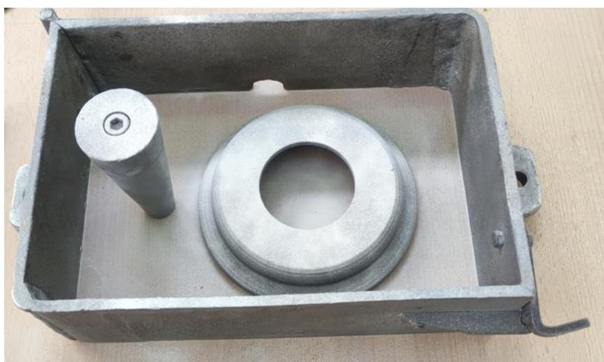
Slika 52. Smještanje modela odljevka i spusta u gornjak
