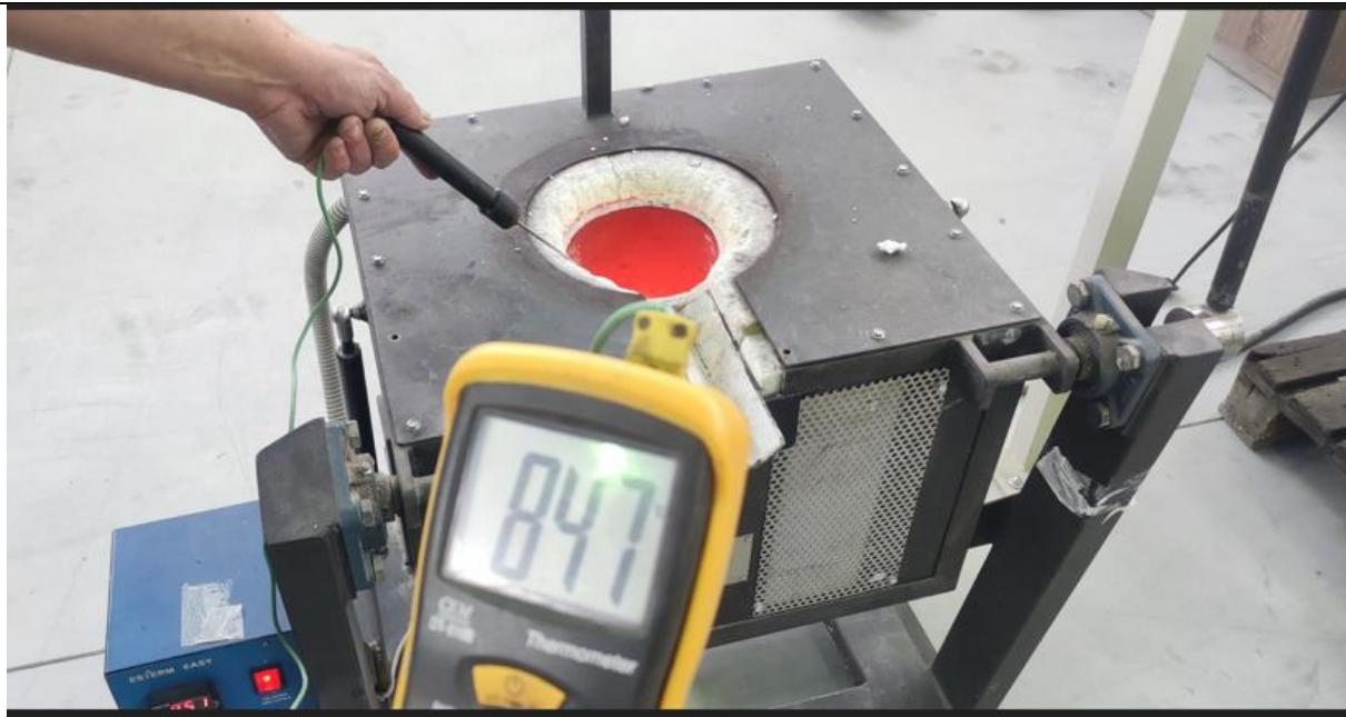
Slika 63. Mjerenje temperature taline
