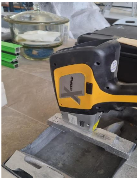
Slika 73. Određivanje kemijskog sastava odljevka XRF metodom
