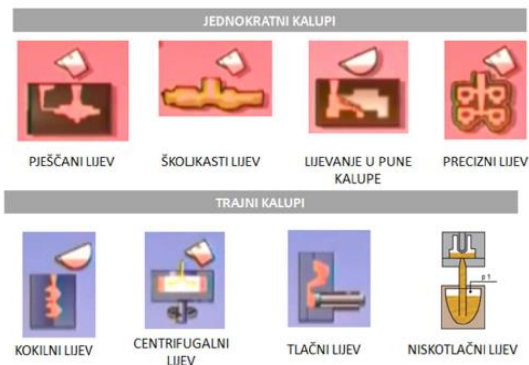
Slika 2 Podjela postupaka lijevanja prema vrsti kalupa [1]
