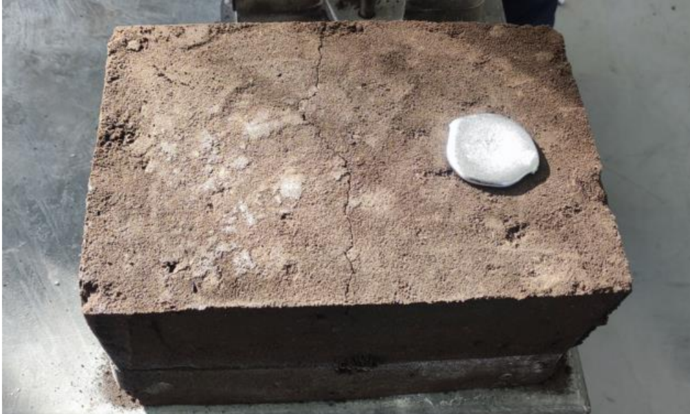
Slika 67. Izgled kalupa nakon skrućivanja
