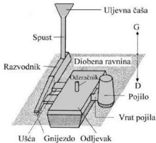
Slika 10. Uljevni sustav [4]
