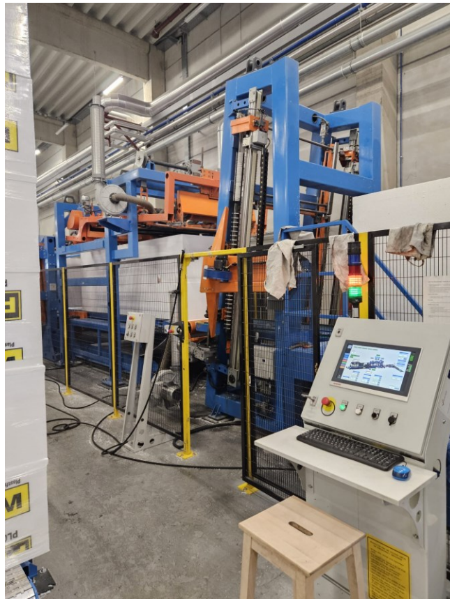
Slika 17. Automatizirani linijski stroj za rezanje i pakiranje
