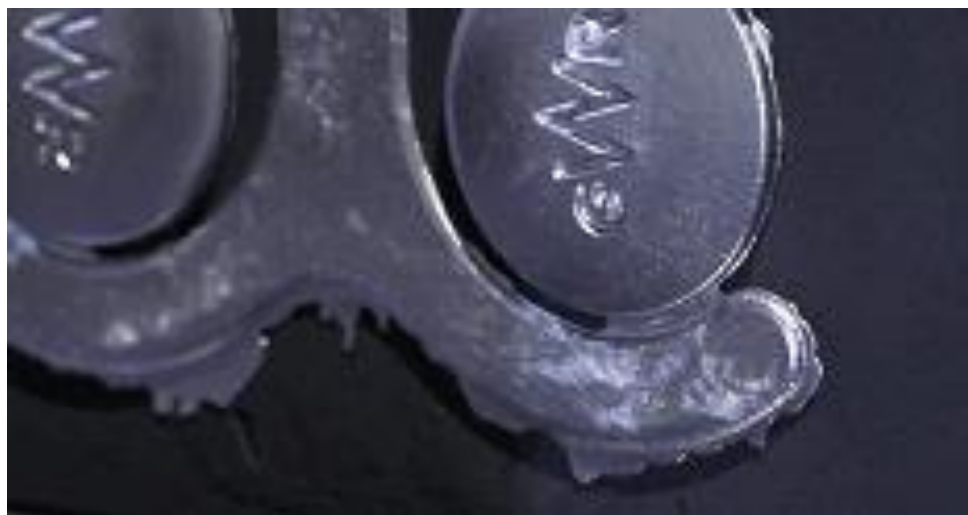
Slika 3.15 Srh na odljevku [21]
