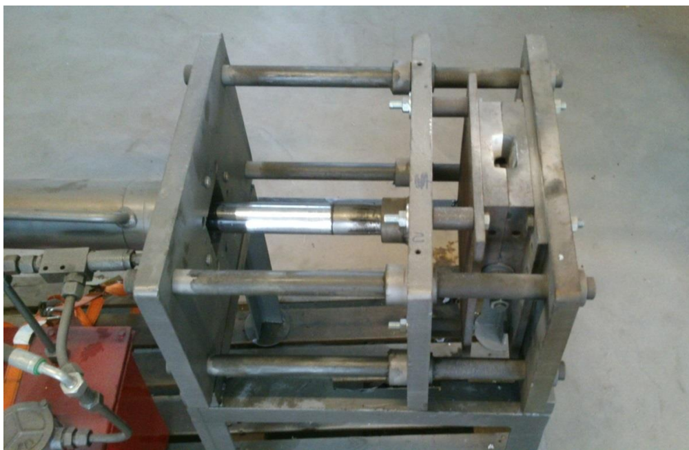
Slika 6.4 Hidraulički mehanizam za otvaranje i zatvaranje
