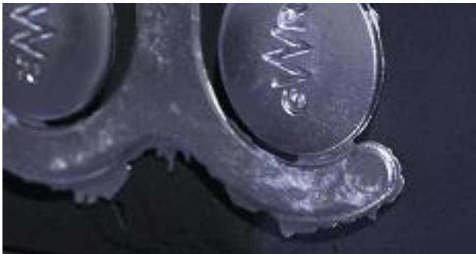
Slika 3.15 Srh na odljevku [21]
