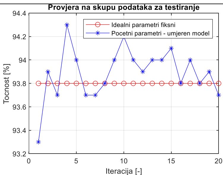
Slika 41 Usporedba točnosti nakon 1000 prolazaka na skupu za testiranje
