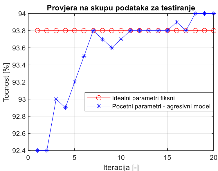
Slika 48 Usporedba točnosti nakon 1000 prolazaka na skupu za testiranje
