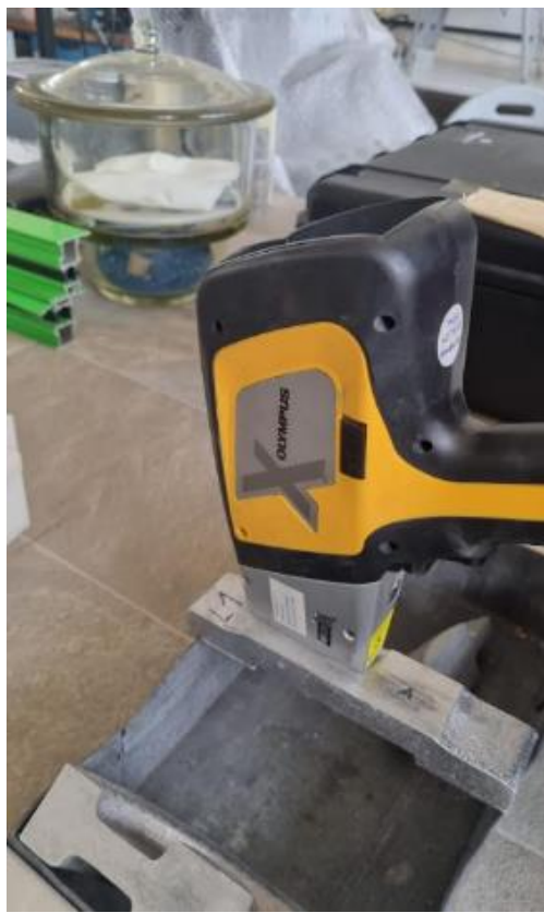
Slika 50. Mjerenje kemijskog sastava odljevka XRF metodom
