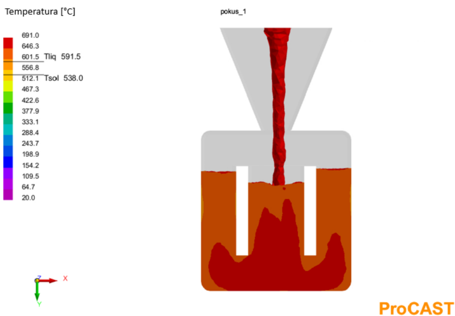
Slika 25. Nastavak punjenja kokile i početak hlađenja taline
