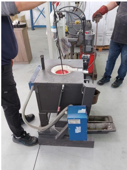
Slika 40. Elektrootporna peć za taljenje metala
