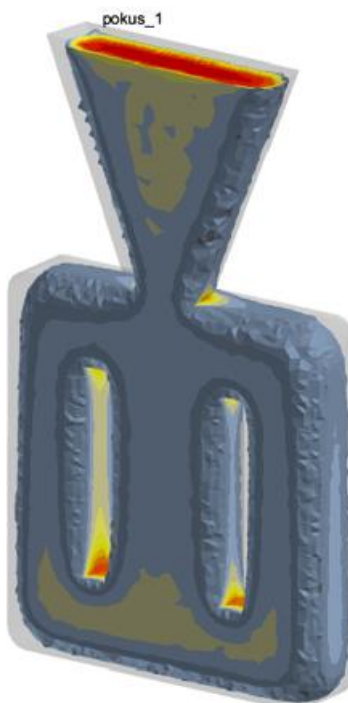
Slika 29. Potpuno skrućivanje rubnih dijelova taline
