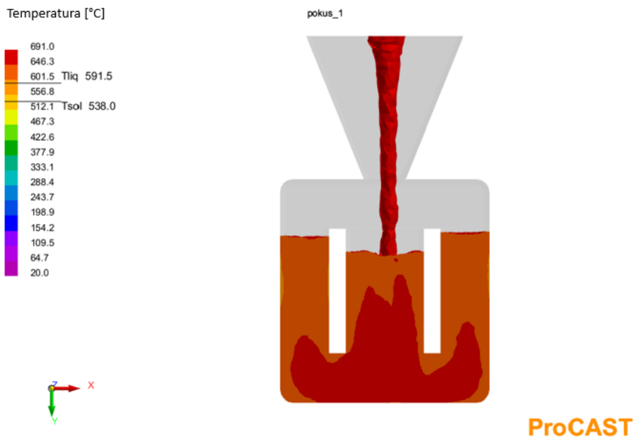
Slika 25. Nastavak punjenja kokile i početak hlađenja taline
