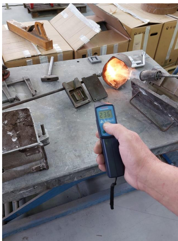
Slika 39. Postignuta temperatura kokile
