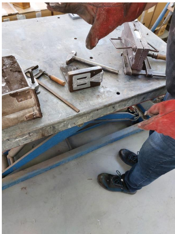
Slika 48. Otvorena kokila s odljevkom
