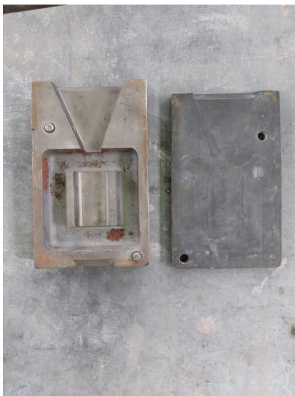
Slika 37. Kokila korištena za lijevanje
