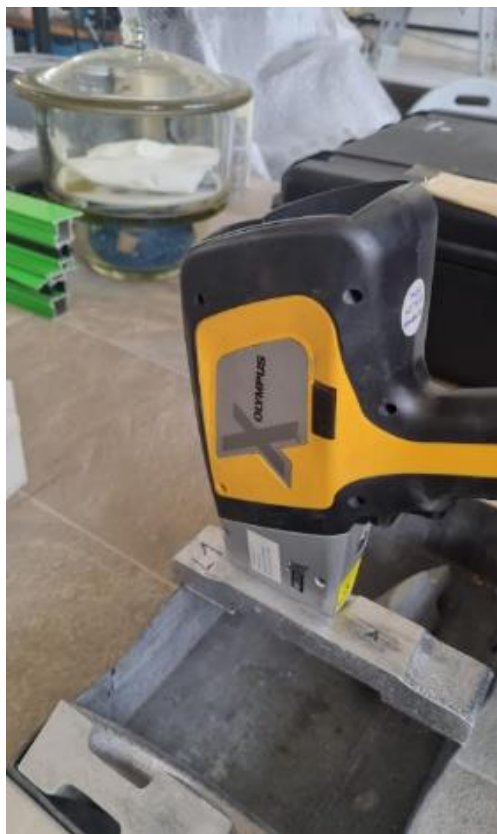
Slika 50. Mjerenje kemijskog sastava odljevka XRF metodom
