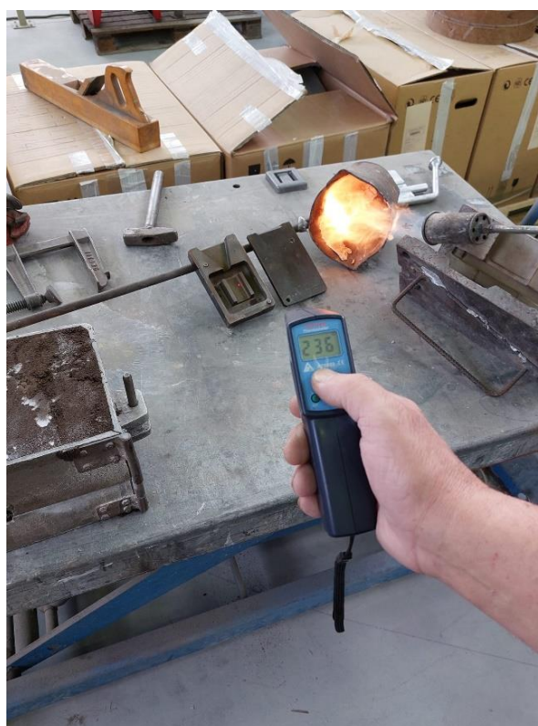
Slika 39. Postignuta temperatura kokile
