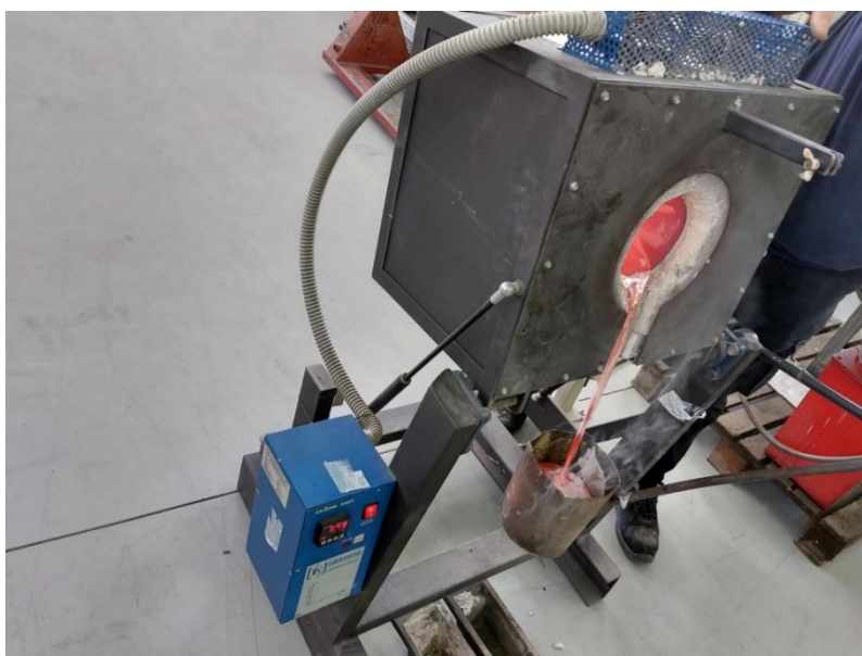
Slika 43. Ulijevanje taline iz peći u lonac za lijevanje
