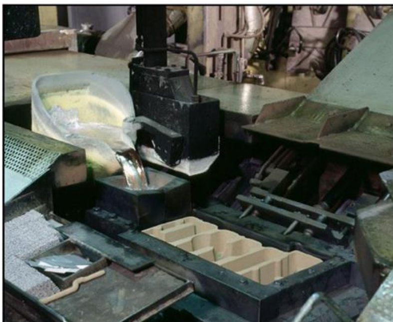
Slika 8. Automatizirano ulijevanje rastaljenog materijala u kalupnu šuplinu [17]
