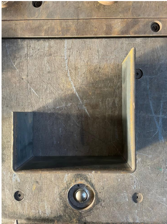
Slika 42. Slika lima nakon oblikovanja
