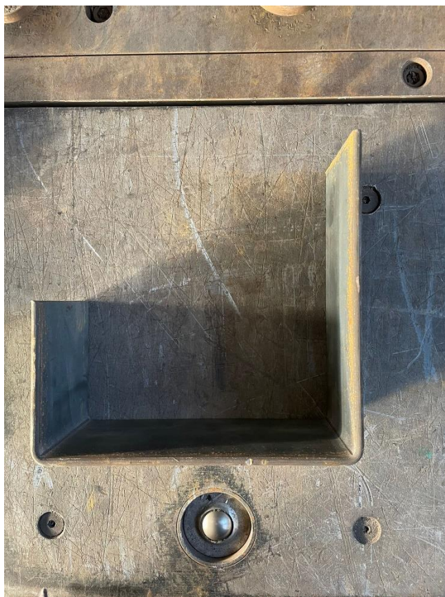
Slika 42. Slika lima nakon oblikovanja
