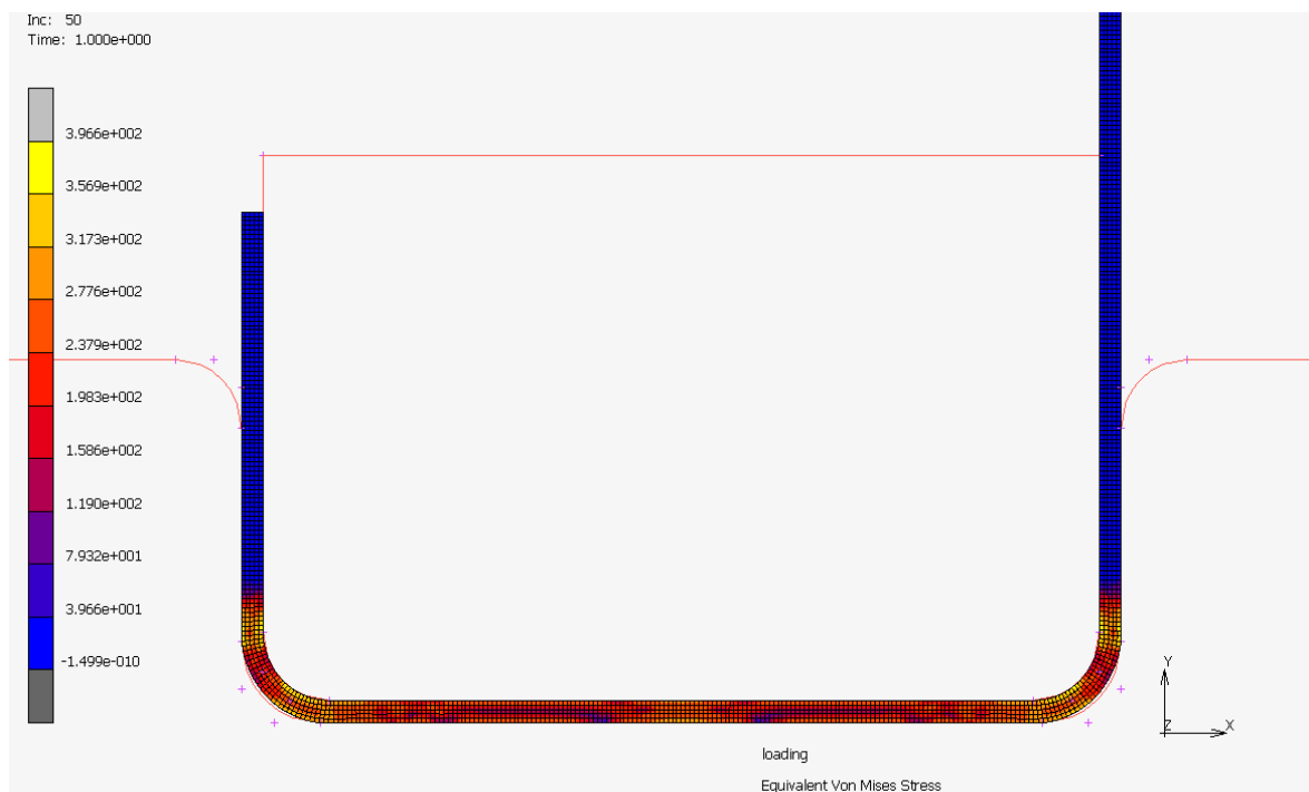
Slika 36. Naprezanje u metalu u donjem položaju gibanja žiga
