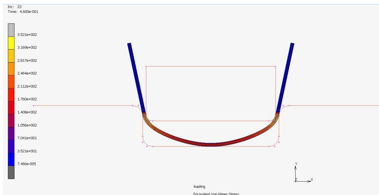
Slika 9.5 Naprezanja tijekom procesa savijanja
