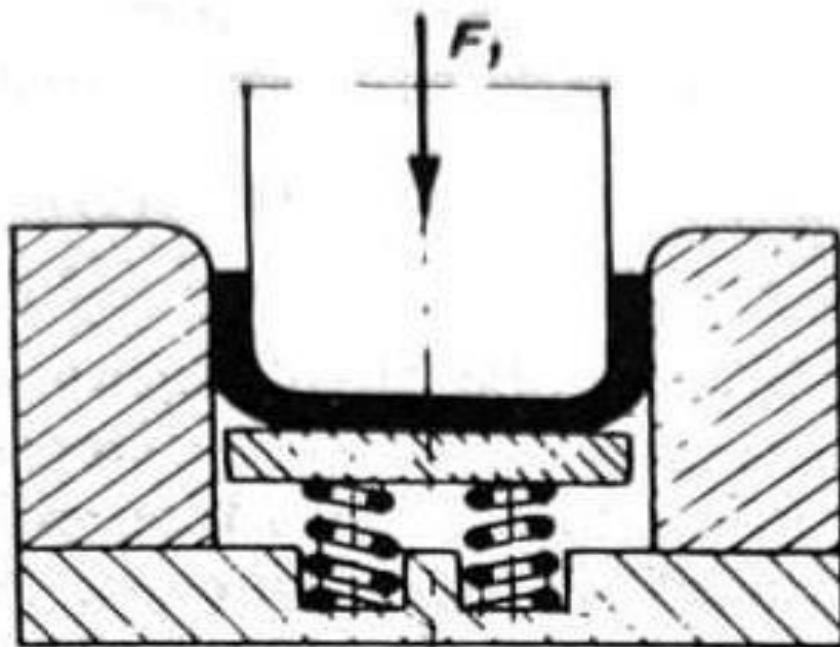
Slika 5.3 Savijanje u kalupu sa izbacivačem [1]
