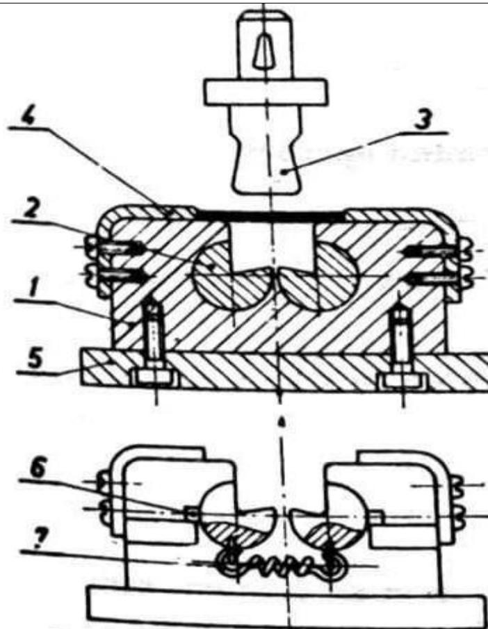
Slika 3.6 Oštro kutno savijanje uz primjenu okretnih valjka [1]
