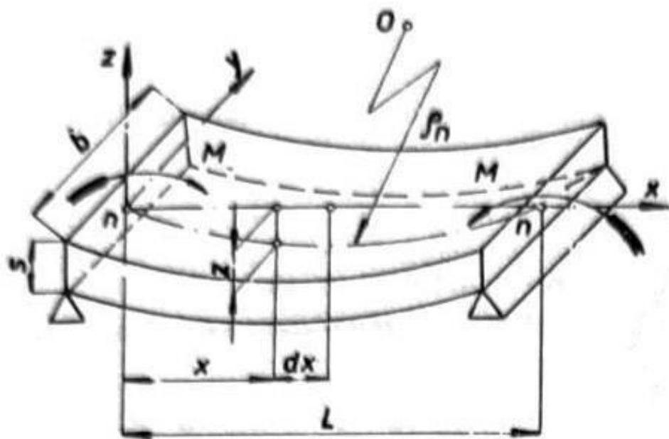
Slika 4.1 Savijanje nosača [1]
