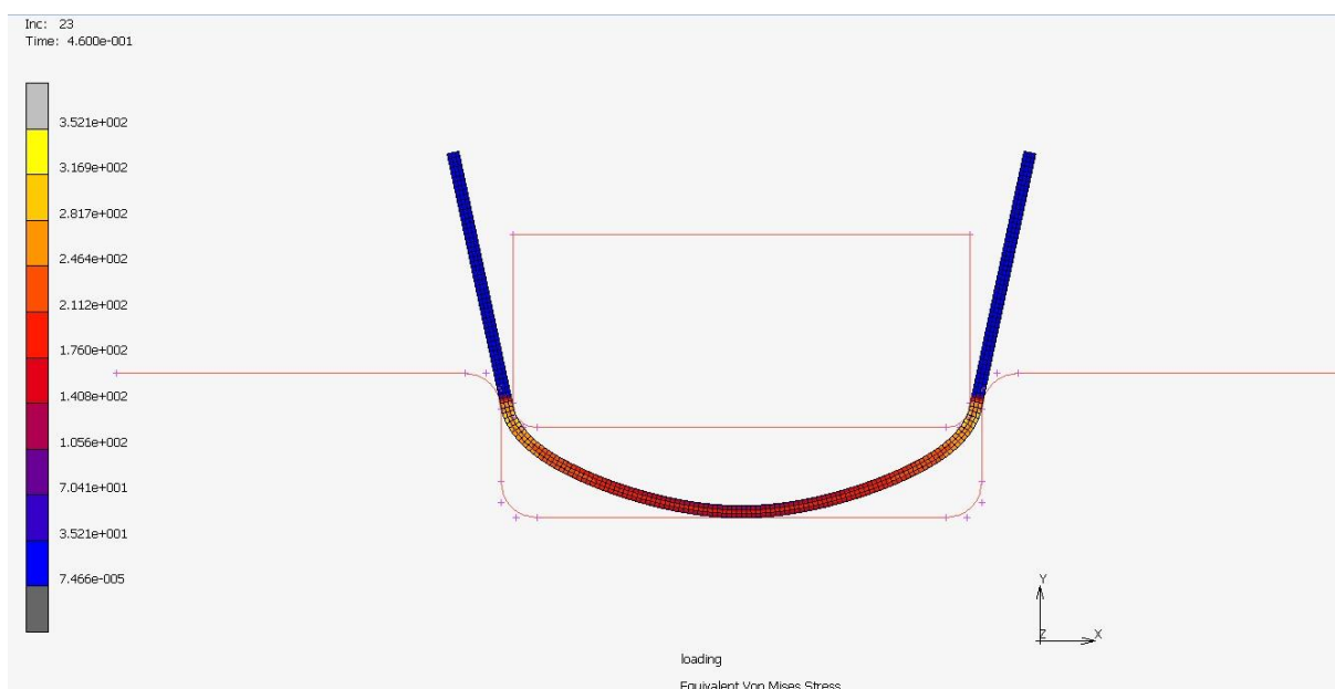
Slika 9.5 Naprezanja tijekom procesa savijanja
