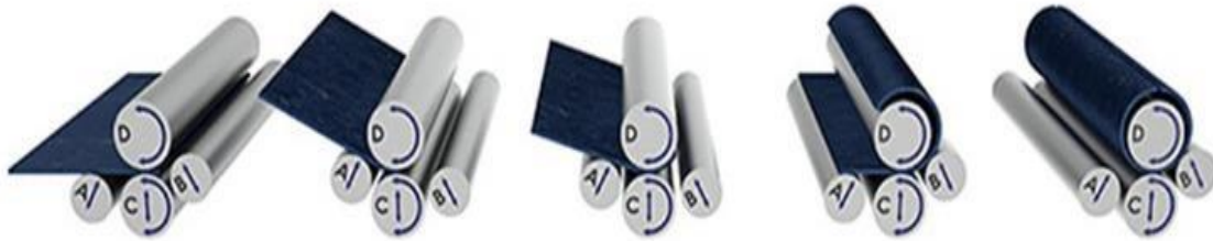
Slika 3.2 Položaj valjka za kružno savijanje s četiri valjka za stroj prema slici 3.1. [3]
