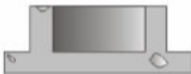
Slika 12. Šupljine na površini u odljevku [8]
