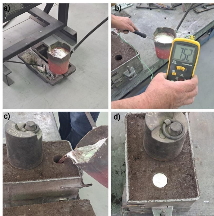
Slika 71. Lijevanje: a) prijenos taljevine loncem, b) mjerenje temperature taljevine, c) ulijevanje taljevine u uljevni sustav, d) hlađenje taljevine
