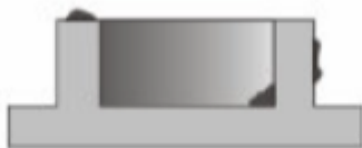
Slika 11. Metalne izrasline na odljevku [8]
