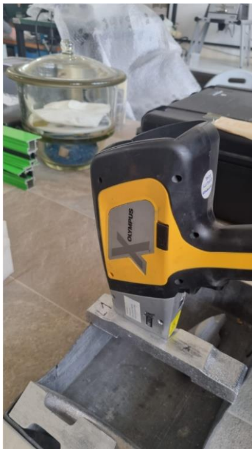
Slika 78. Određivanje kemijskog sastava odljevka XRF metodom
