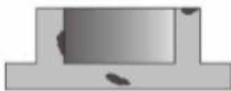
Slika 17. Uključci i heterogenosti odljevka [8]
