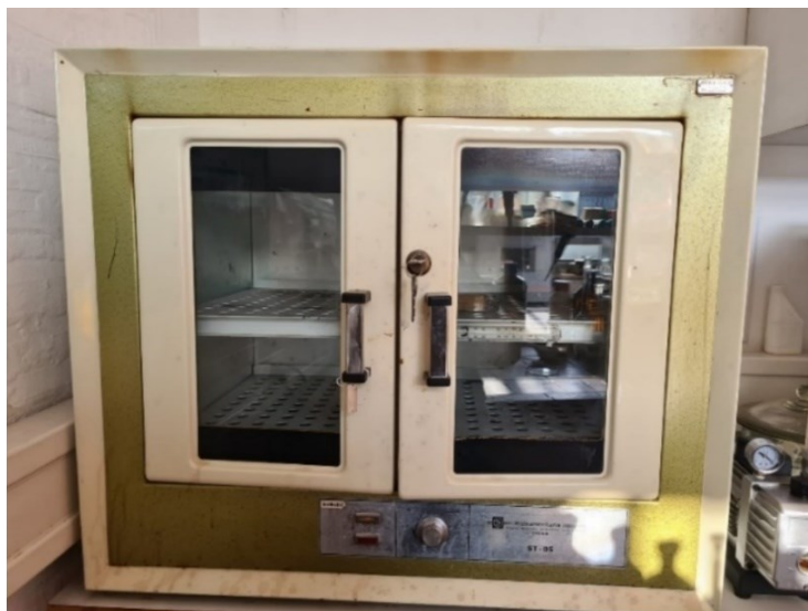
Slika 7.12. Peć za sušenje uzorka
