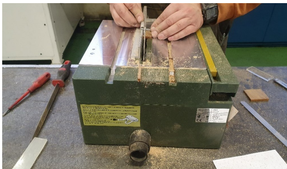
Slika 7.16. Stolna pila FET za izrezivanje uzoraka za mjerenje na Taber abraderu
