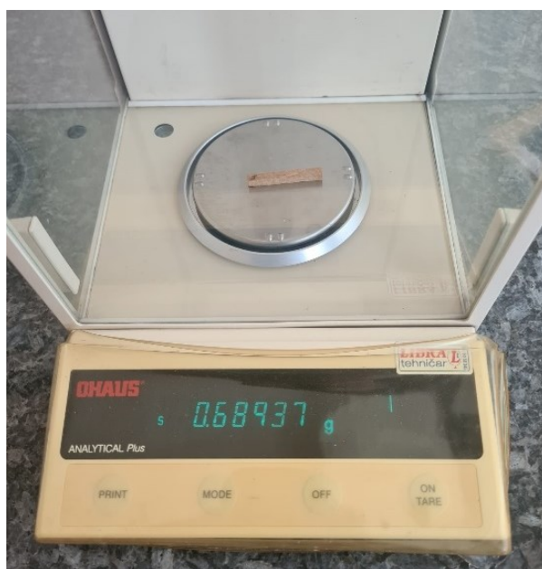
Slika 7.20. Izmjerena masa jednog od uzoraka pomoću vage Ohaus Analytical Plus
