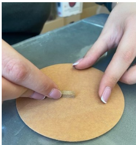
Slika 7.18. Proces finog brušenja uzoraka
