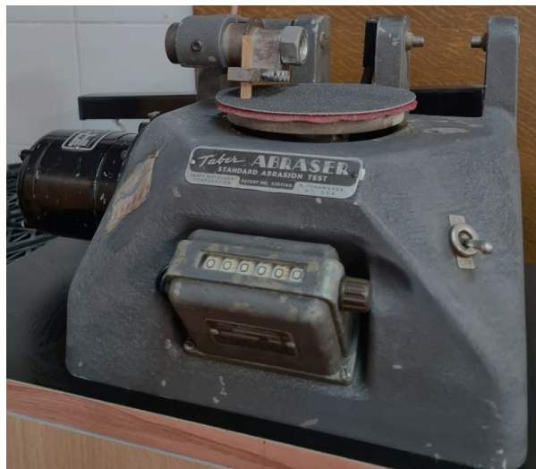
Slika 7.21. Uređaj Taber abrader
