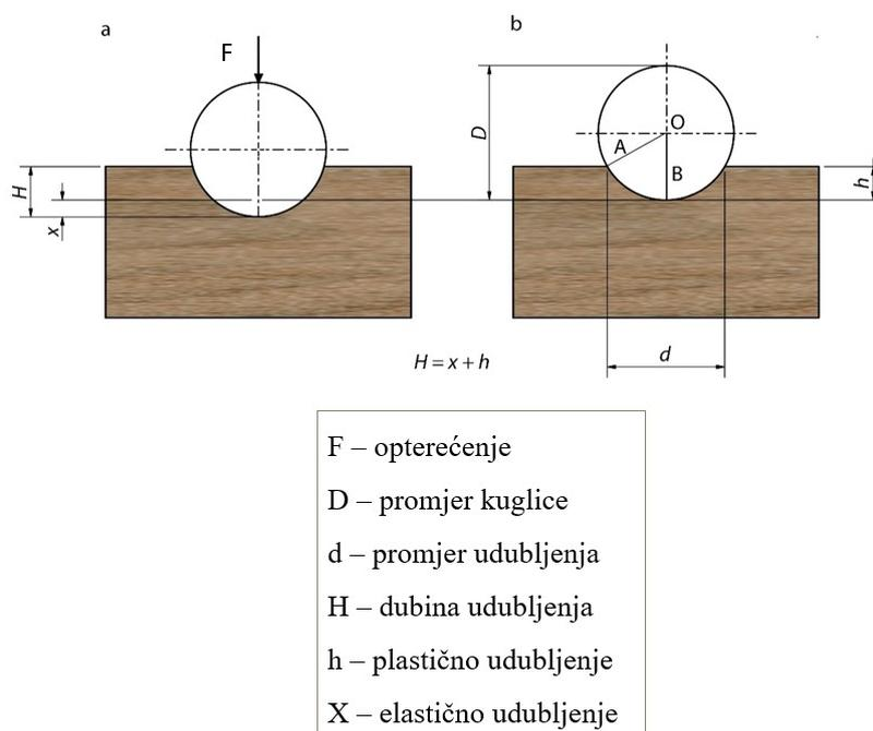
**Slika 5.7. Geometrijska povezanost (a) kuglica pod opterećenjem, (b) kuglica nakon opterećenja [21]**
