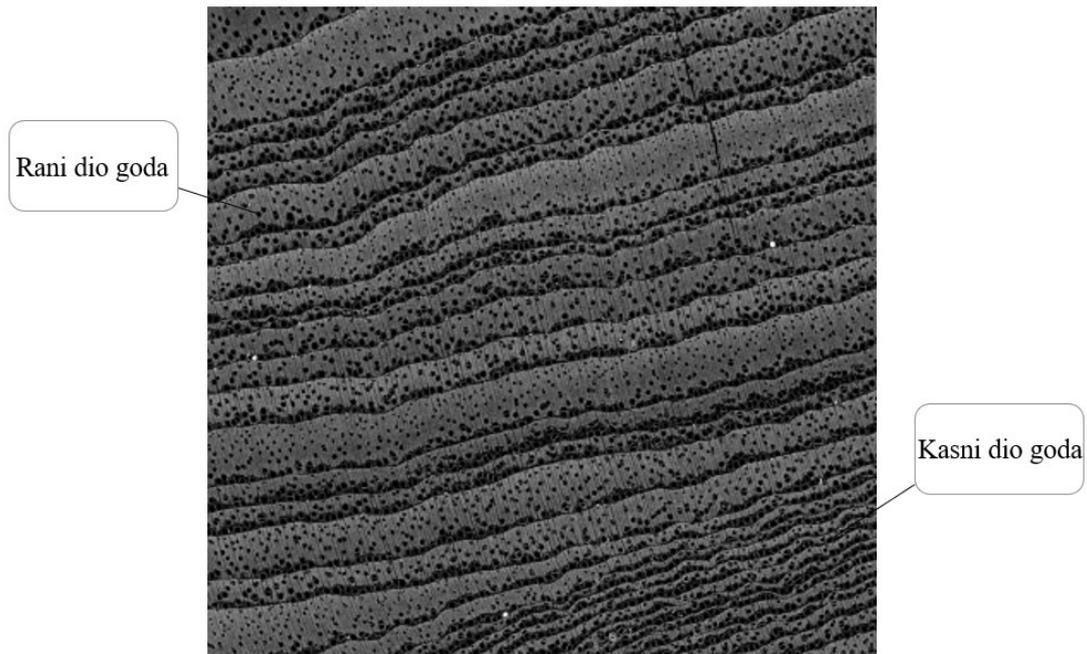
Slika 7.8. CT snimka mikrostrukture u poprečnom presjeku tikovine
