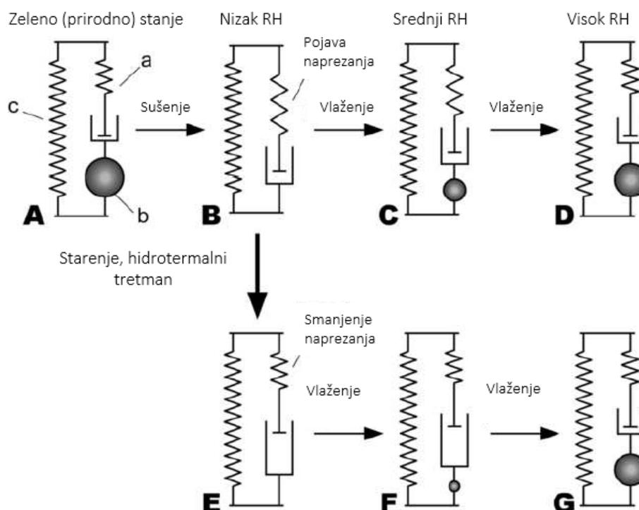
Slika 5.11. Shema mehanizma unutarnjeg naprezanja pri sušenju drva [25]
