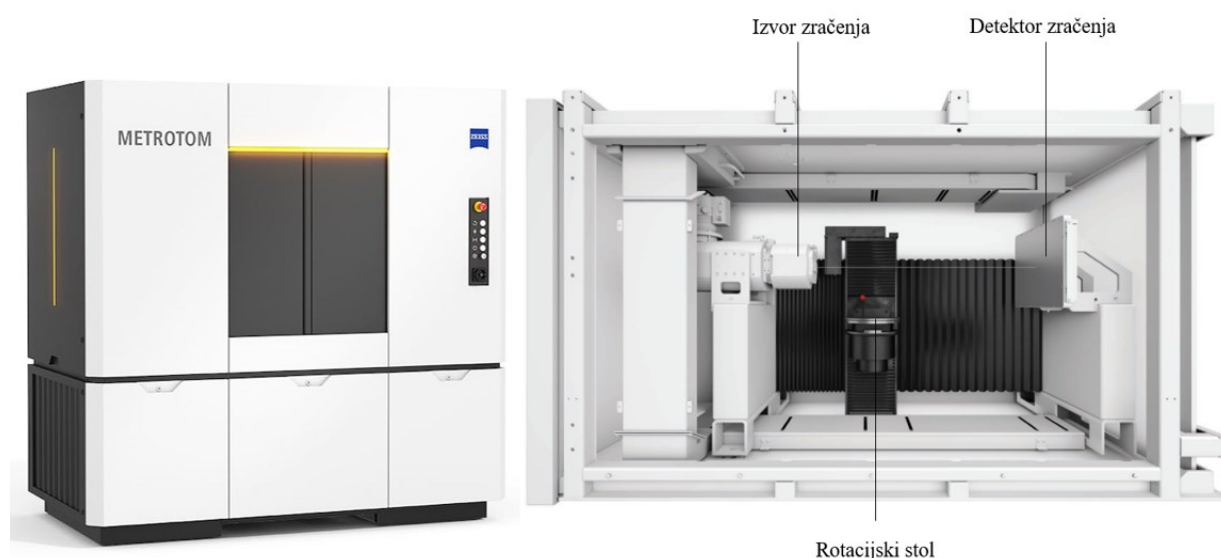
Slika 7.7. CT uređaj ZEISS Metrotom 6 Scout [29]
