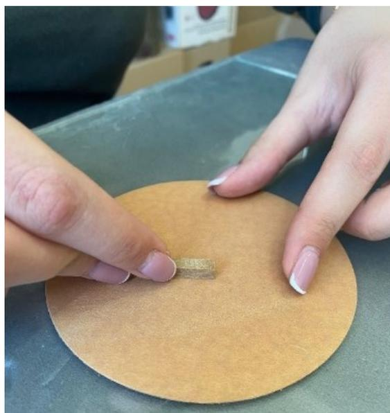
**Slika 7.18. Proces finog brušenja uzoraka**
