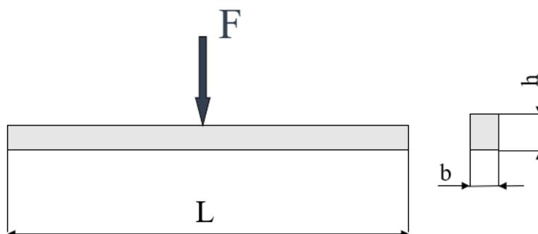
Slika 5.3. Određivanje modula elastičnosti u praksi u tri točke
