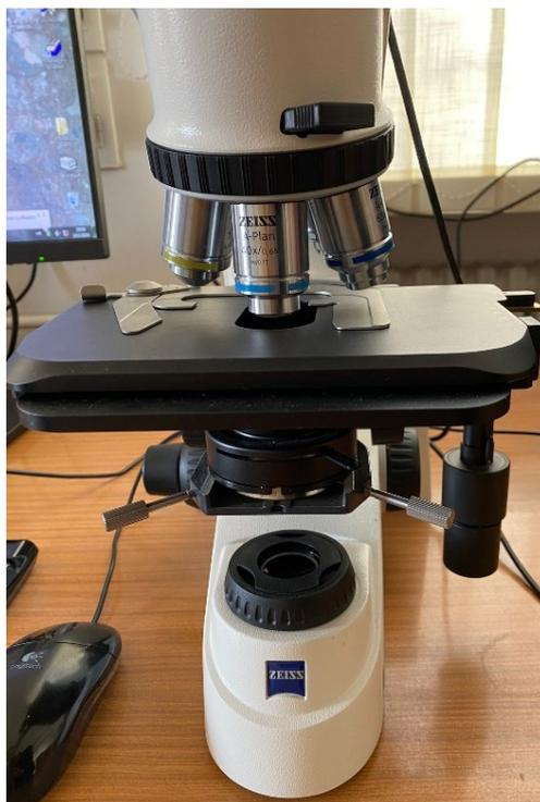
**Slika 7.3. Svjetlosni mikroskop za analizu mikrostrukture**
