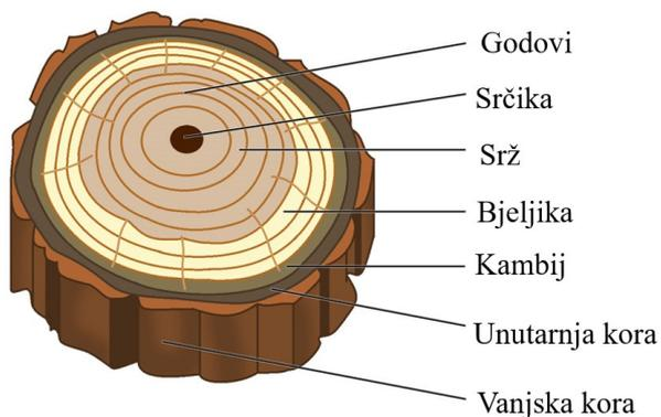
**Slika 2.3. Dijelovi debla na poprečnom presjeku [6]**
