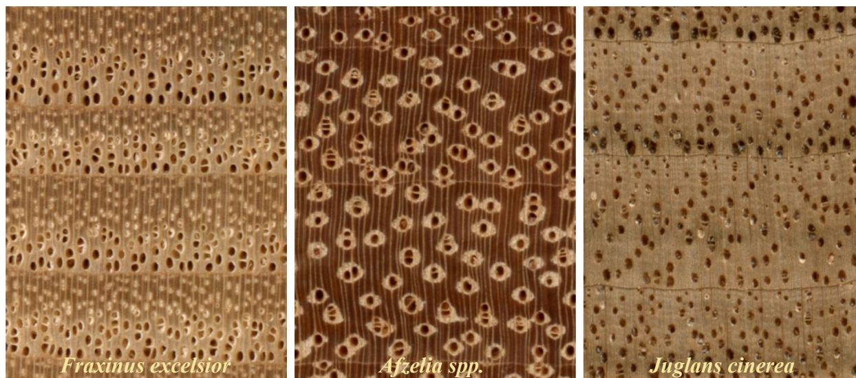
Slika 3.9. Prstenasto porozna (lijevo), difuzno porozna (sredina) i semi-prstenasto porozna vrsta (desno) [14]
