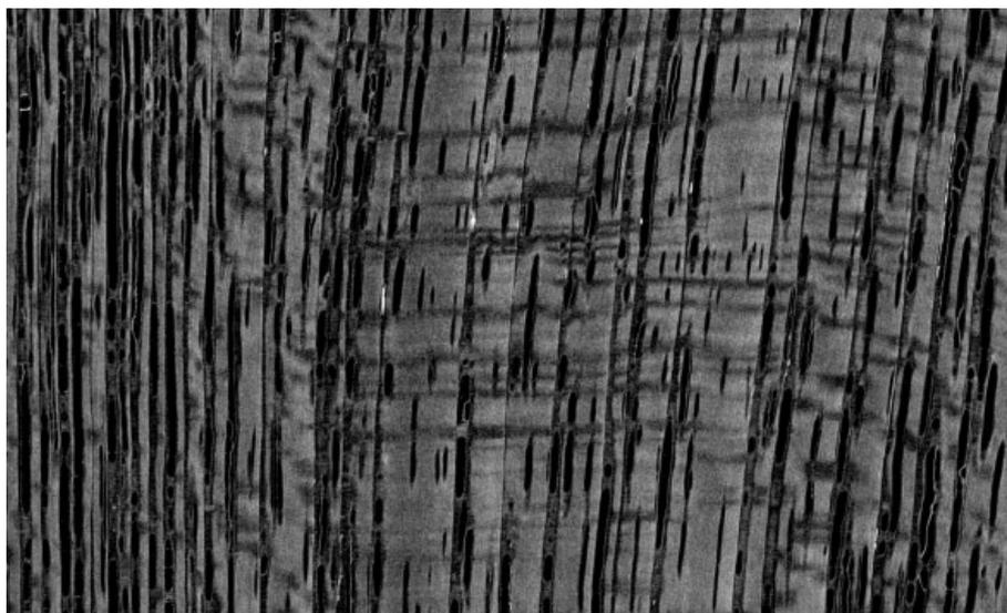
Slika 7.10. CT snimka mikrostrukture u radijalnom presjeku tikovine
