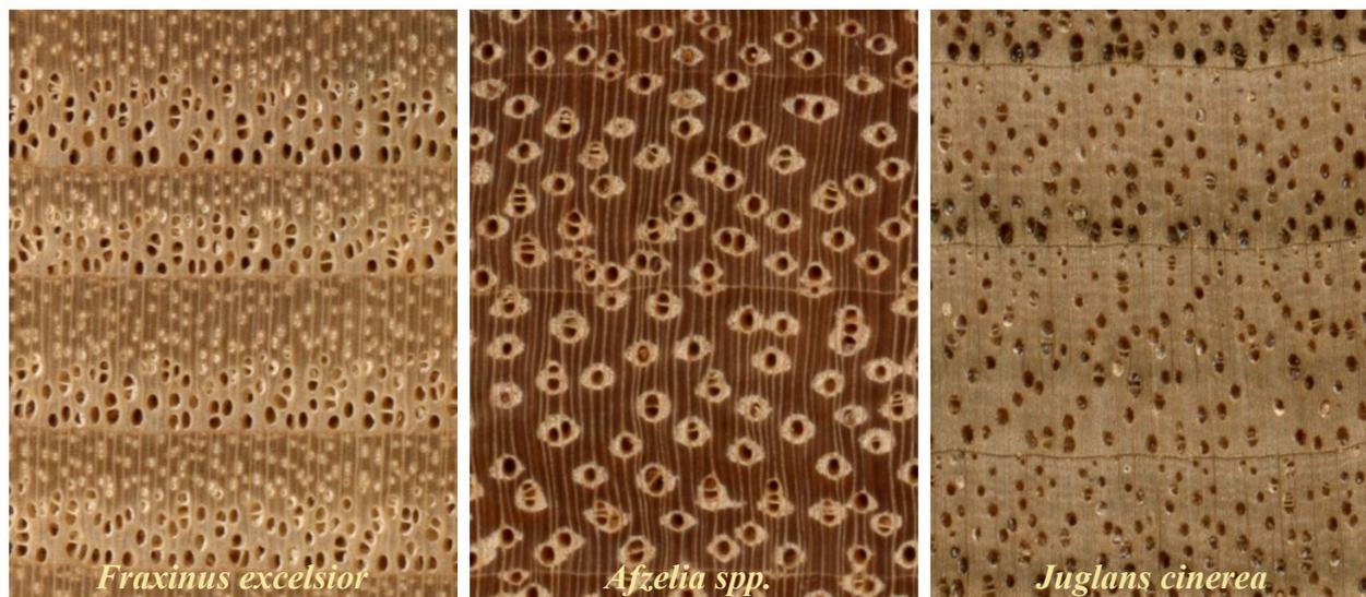
Slika 3.9. Prstenasto porozna (lijevo), difuzno porozna (sredina) i semi-prstenasto porozna vrsta (desno) [14]
