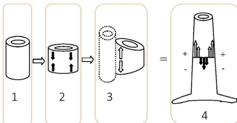
Slika 3.1. Naprezanja pri rastu drvnih stanica [9]
