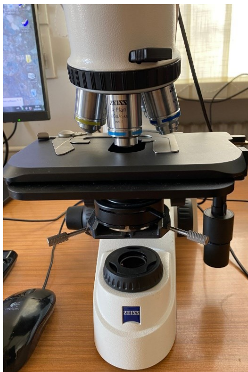
Slika 7.3. Svjetlosni mikroskop za analizu mikrostrukture
