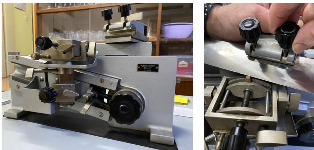
Slika 7.2. Izrezivanje uzoraka za analizu mikrostrukture na Microtomu
