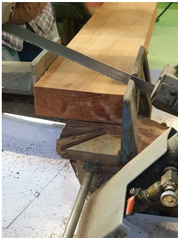
Slika 7.15. Tračna pila za izrezivanje uzoraka
