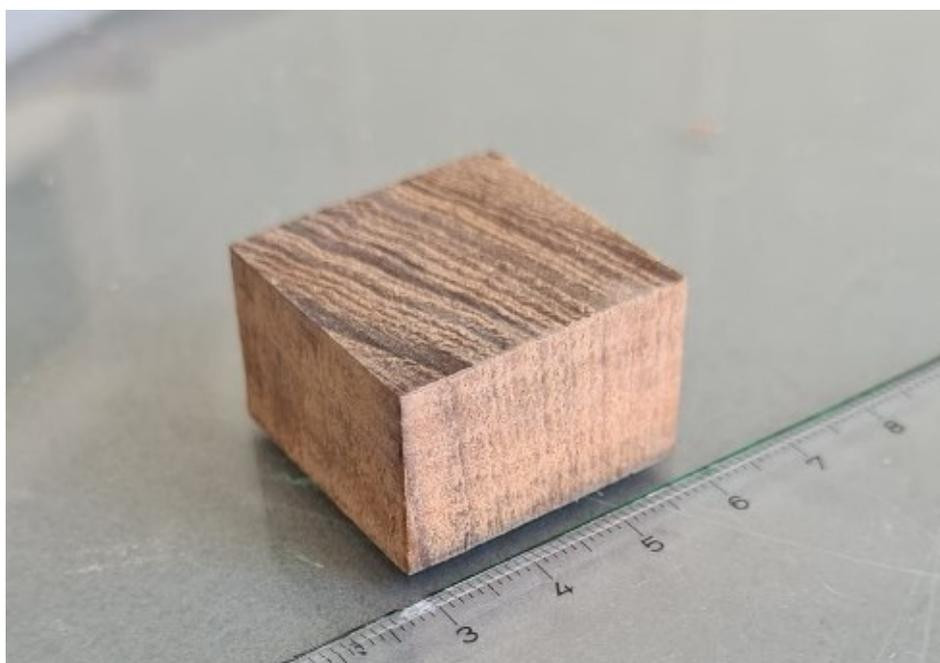
Slika 7.11. Uzorak za određivanje gustoće i udjela vlage
