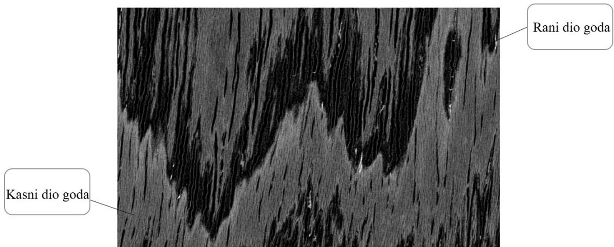
Slika 7.9. CT snimka mikrostrukture u tangencijalnom presjeku tikovine
