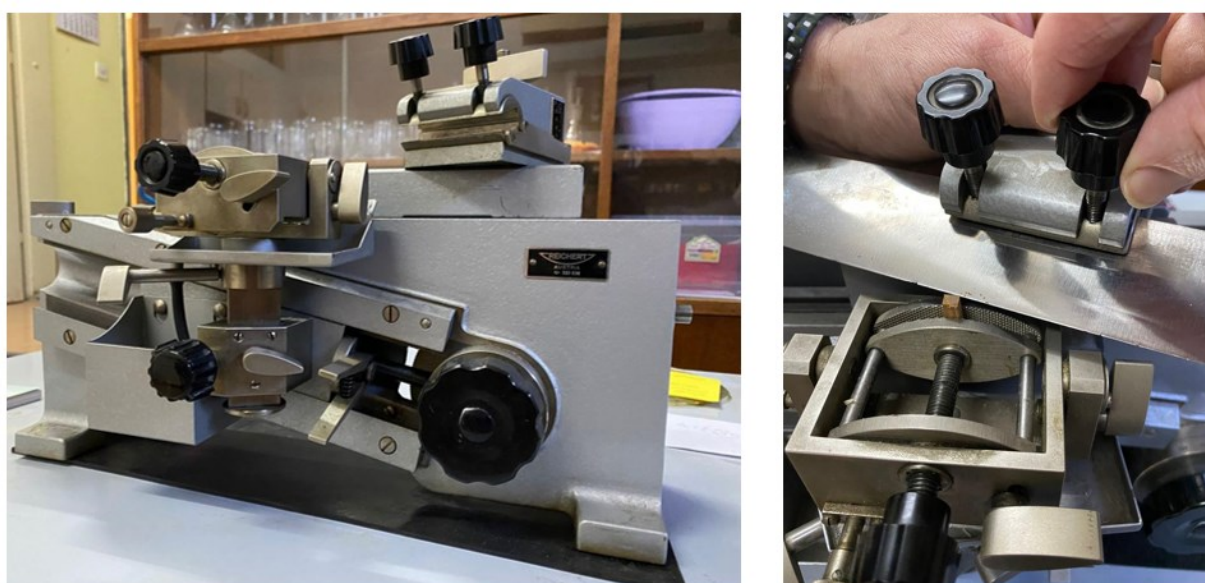
Slika 7.2. Izrezivanje uzoraka za analizu mikrostrukture na Microtomu
