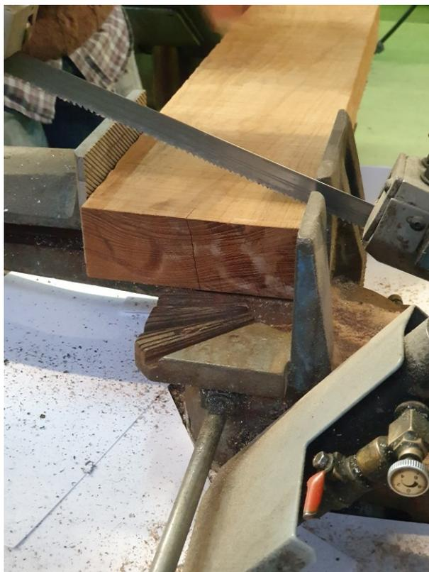
**Slika 7.15. Tračna pila za izrezivanje uzoraka**
