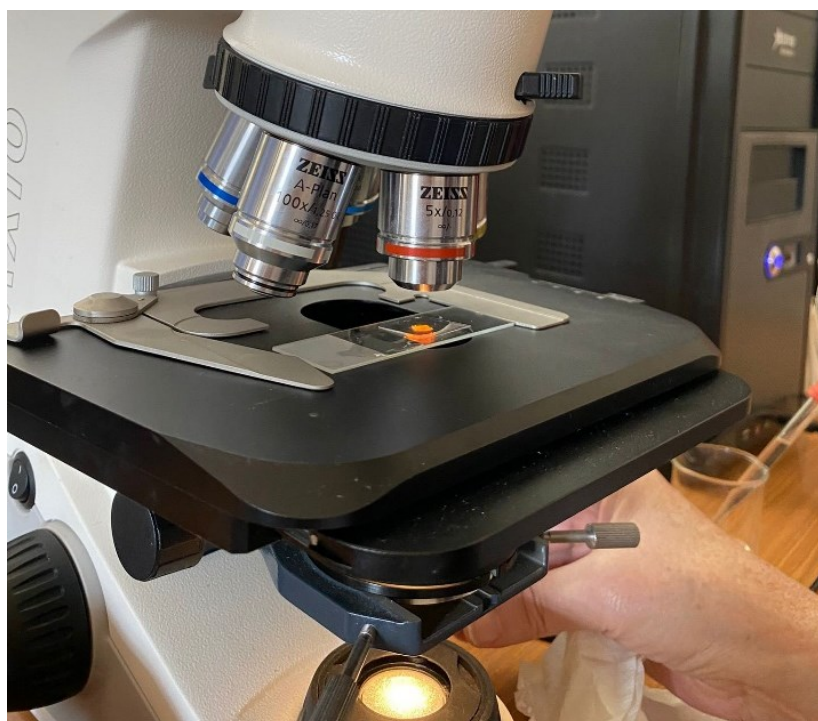
Slika 27. Ispitivanje mikrostrukture tikovine
