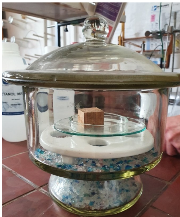
Slika 33. Eksikator za prijenos uzorka
