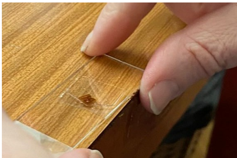
Slika 26. Vrlo tanak uzorak za ispitivanje mikrostrukture
