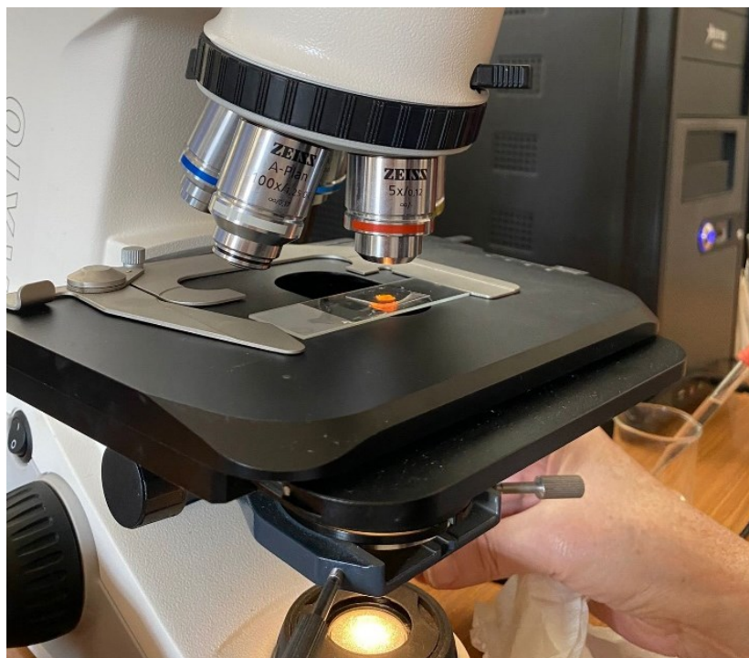
Slika 27. Ispitivanje mikrostrukture tikovine
