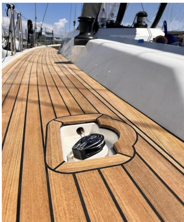
Slika 24. Dio montirane palube od tikovine
