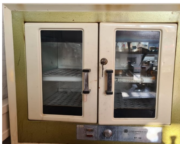
Slika 32. Sušionik u kojem je sušen uzorak
