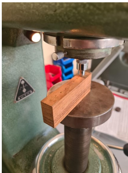
Slika 16. Ispitivanje tvrdoće tikovine
