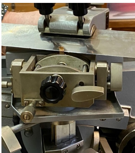
Slika 25. Rezanje tankih uzoraka na mikrotomu
