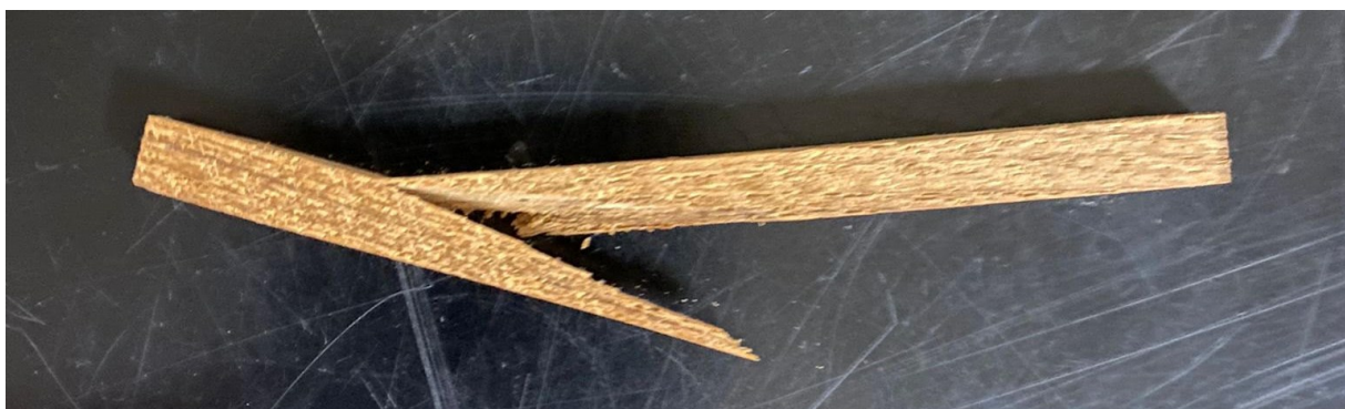
Slika 45. Ispitni uzorak nakon loma
