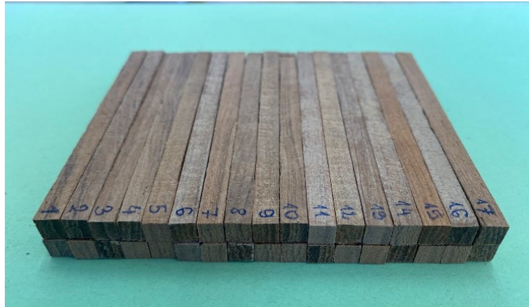
Slika 40. Uzorci s kutom između sile i goda od 0^\circ
