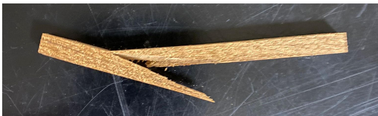
Slika 45. Ispitni uzorak nakon loma
