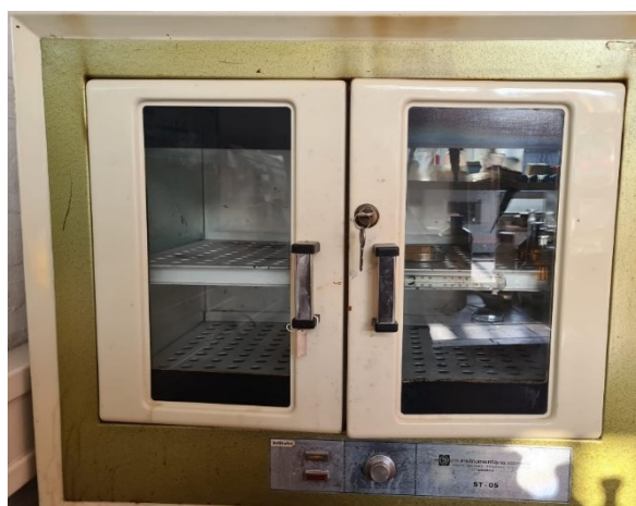
Slika 32. Sušionik u kojem je sušen uzorak
