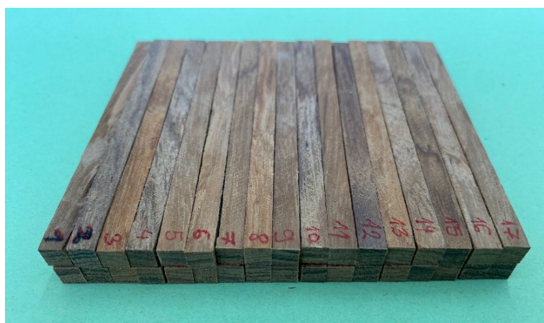
Slika 42. Uzorci s kutom između sile i goda od 90^\circ
