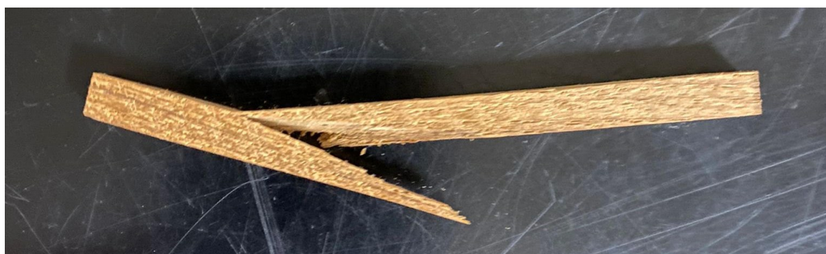
Slika 45. Ispitni uzorak nakon loma
