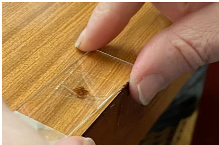
Slika 26. Vrlo tanak uzorak za ispitivanje mikrostrukture
