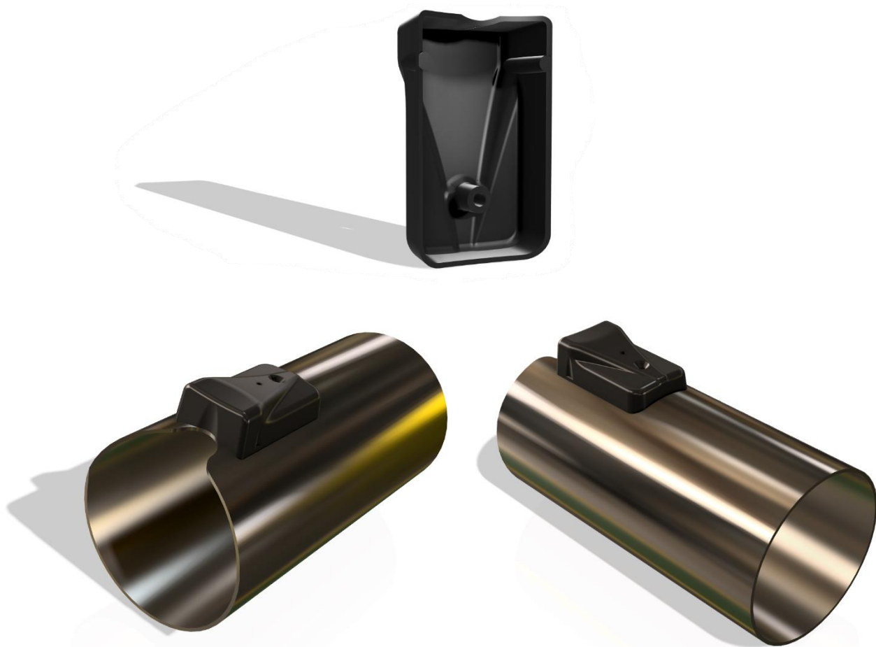
Slika 16 CAD model treće verzije zaštitne kutije prikazane na vanjskoj cijevi
