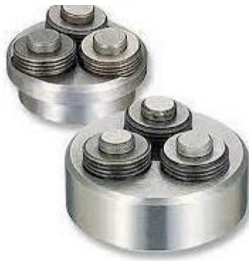
Slika 3 Alat za utiskivanje vanjskog navoja [7]
