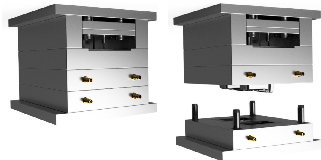
Slika 58 Cijeli alat za injekcijsko prešanje kutije.
