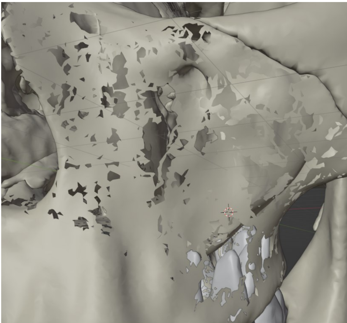
Slika 34. Rupičasta struktura STL modela
