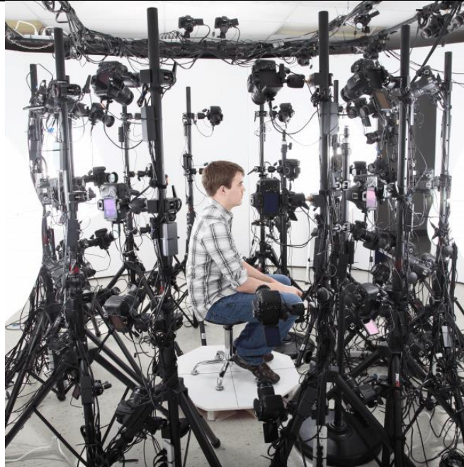
Slika 10 Fotogrametrija pomoću više fotoaparata [7]
