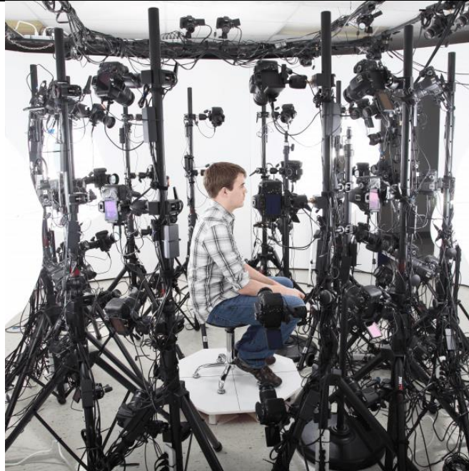
Slika 10 Fotogrametrija pomoću više fotoaparata [7]
