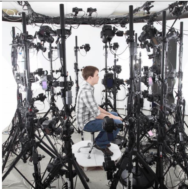
Slika 10 Fotogrametrija pomoću više fotoaparata [7]
