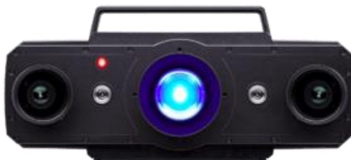
Slika 10. Optički mjerni uređaj ATOS 5X [15]
