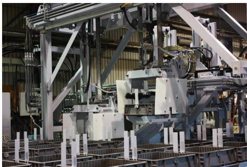
Slika 7. Automatizirana proizvodnja odljevaka u jednokratnim kalupima [4]
