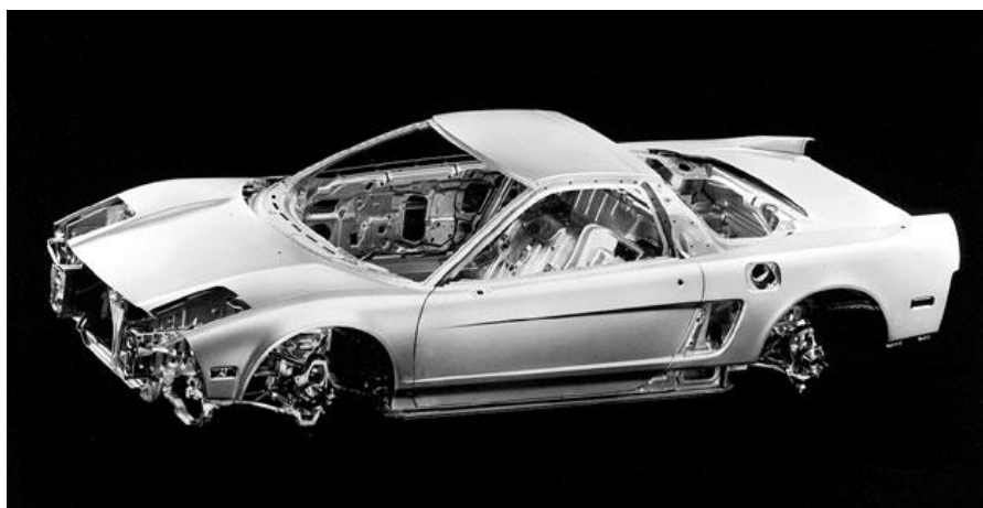
Slika 11. Prva automobilska jednodijelna konstrukcija od aluminija [9]
