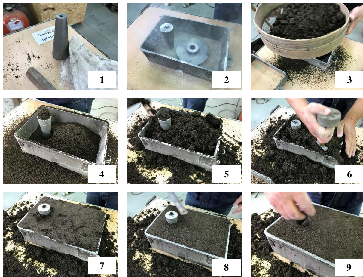
Slika 40. Postupak izrade gornjaka
