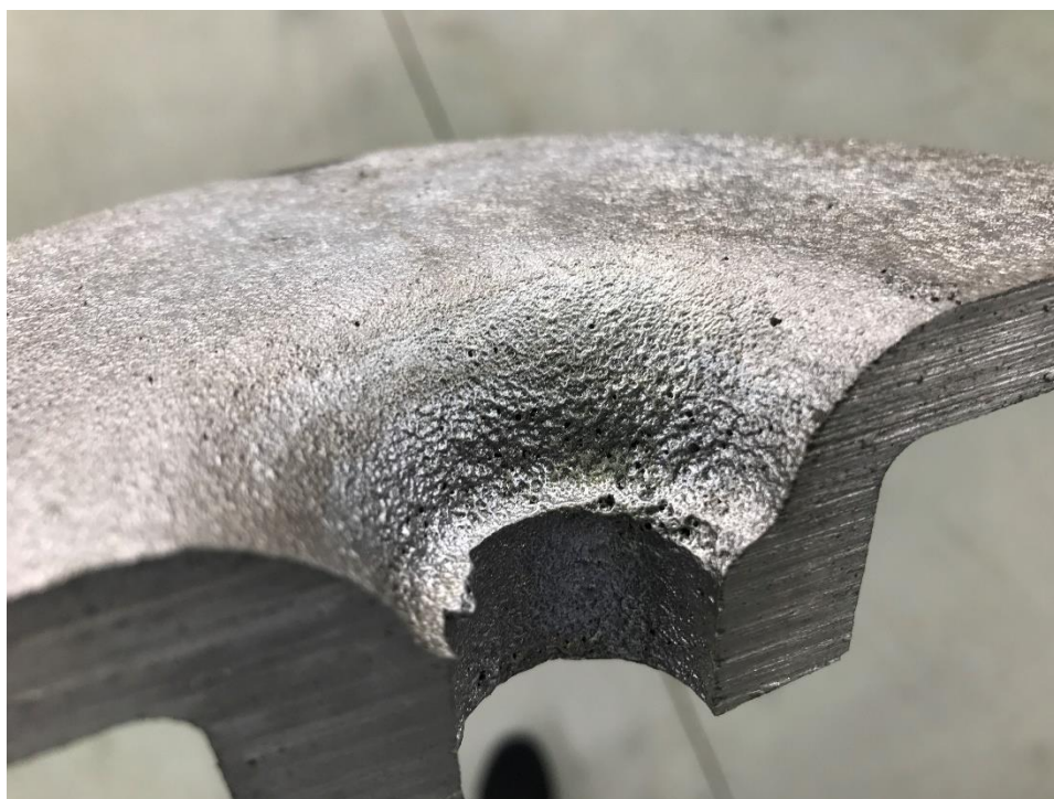
Slika 49. Poroznost na donjem radijusu odljevka
