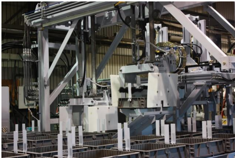
Slika 7. Automatizirana proizvodnja odljevaka u jednokratnim kalupima [4]
