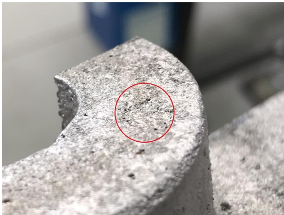
Slika 50. Usahlina na gornjoj površini odljevka
