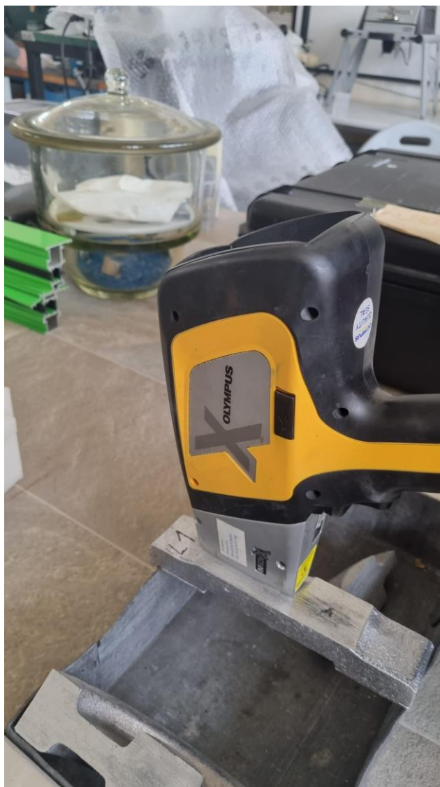
Slika 52. Određivanje kemijskog sastava odljevka XRF metodom
