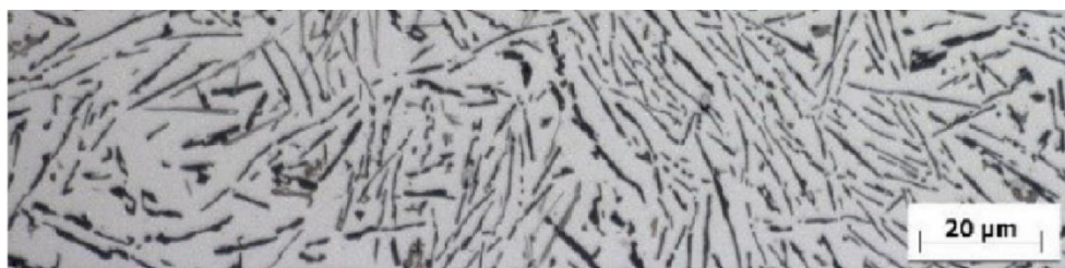
Slika 14. Mikrostruktura legure AlSi12 [14]
