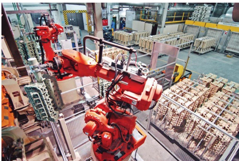
Slika 9. Automatizirani proizvodni pogon za lijevanje bloka motora u BMW-u [6]
