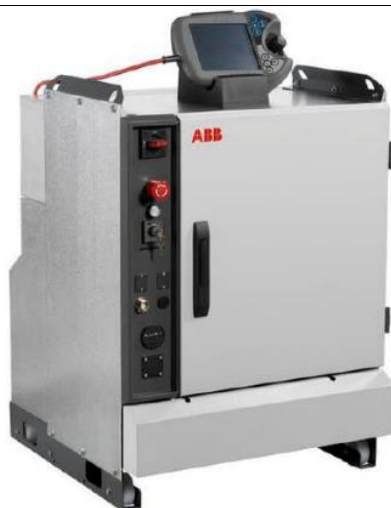
Slika 9. Upravljački sustav robota s operatorskim panelom [8]
