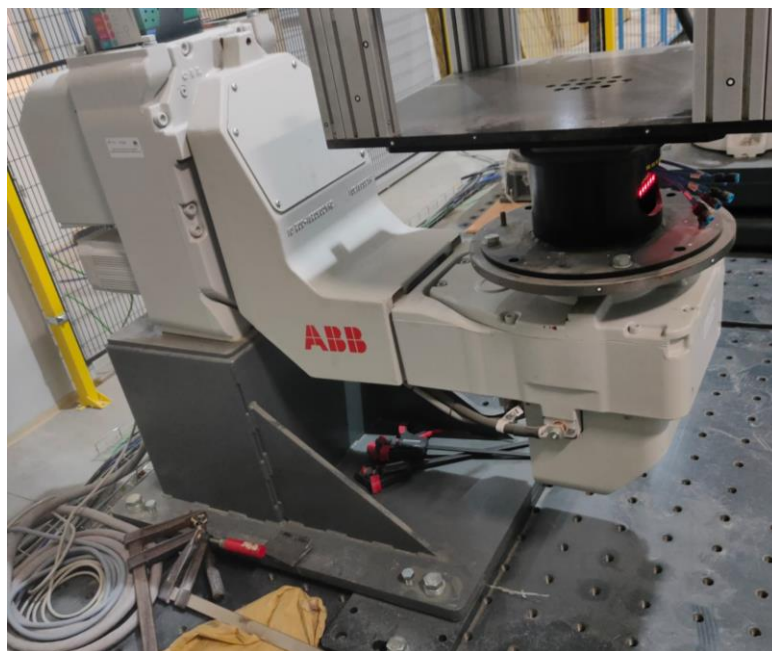
Slika 7. ABB-IRBP-A-500-1000 postavljen u robotskoj obradnoj ćeliji
