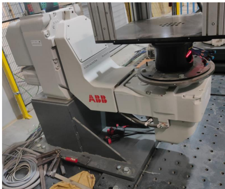
Slika 7. ABB-IRBP-A-500-1000 postavljen u robotskoj obradnoj ćeliji
