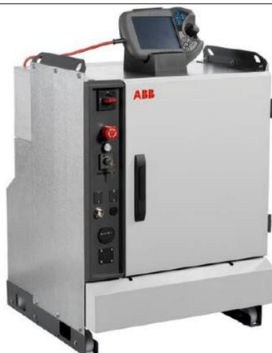
Slika 9. Upravljački sustav robota s operaterskim panelom [8]
