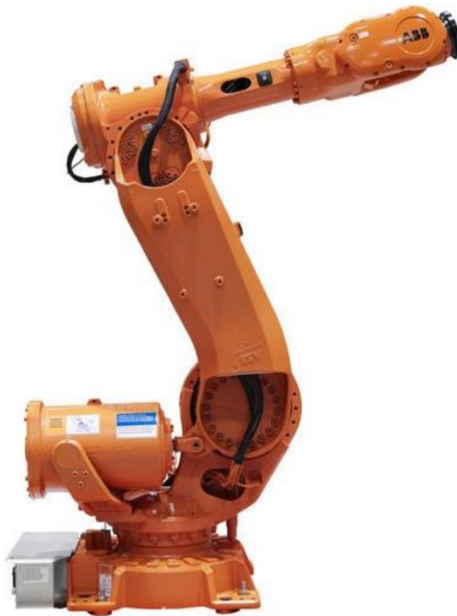
Slika 5. Robot ABB IRB 6640-235-2.55 [5]
