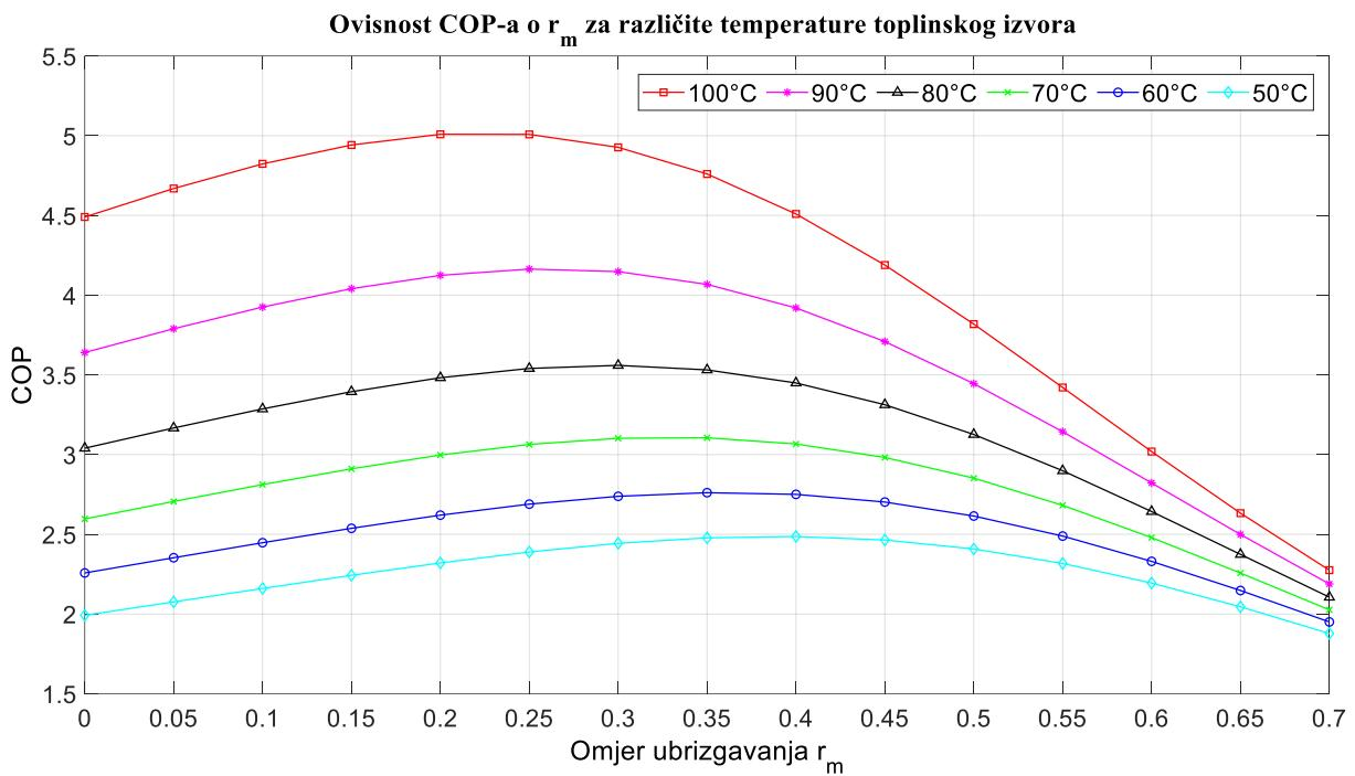
Slika 50. Ovisnost COP-a o  $r_m$  – Temperatura toplinskog ponora  $120^\circ\text{C}$
