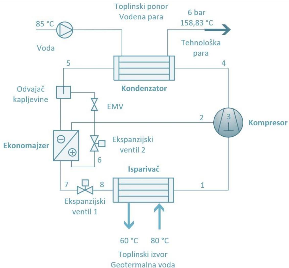
Slika 45. Shematski prikaz visokotemperaturne dizalice topline - EVI
