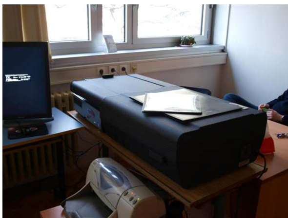
Slika 29. Skener radiografskih filmova –FSB
