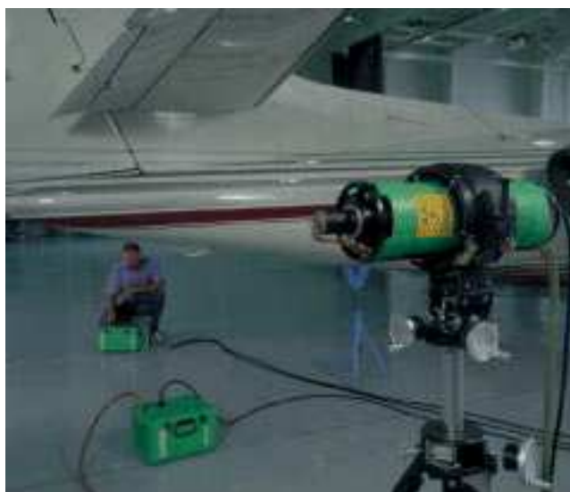
Slika 8. Prenosivi generator X-zraka "LPX series X-ray", priprema prije snimanja [9]
