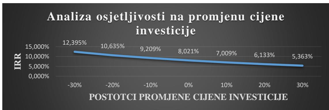
**Dijagram 4. Analiza osjetljivosti ekonomске isplativosti plutajuće odobalne vjetroelektrane na promjenu cijene investicije**
