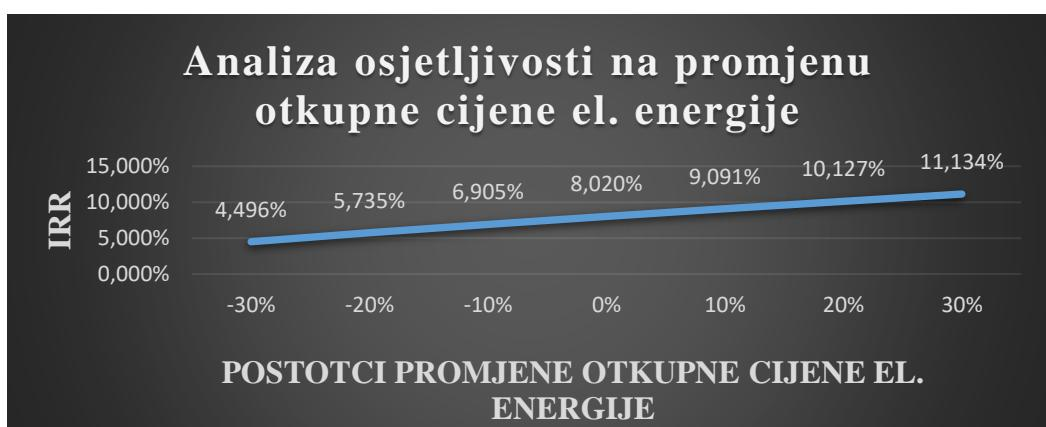
**Dijagram 1. Analiza osjetljivosti ekonomске isplativosti fiksne odobalne vjetroelektrane na promjenu otkupne cijene električne energije**
