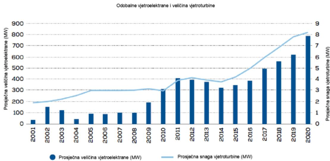
Slika 4. Rast pučinskih vjetroelektrana i veličine instaliranih turbina [10]
