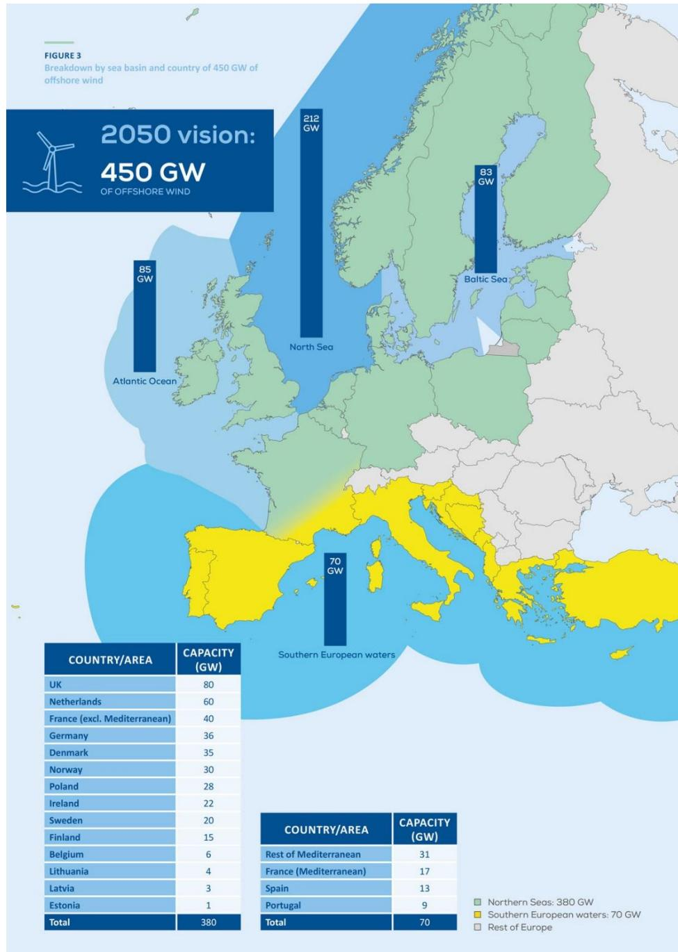
Slika 10. Raspodjela instaliranog kapaciteta odobalnih vjetroturbina u 2050. [12]
