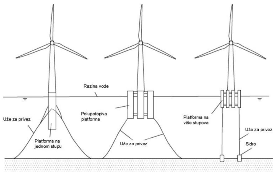
**Slika 46. Načini izvedbe temelja za plutajuće odobalne vjetroturbine [22]**
