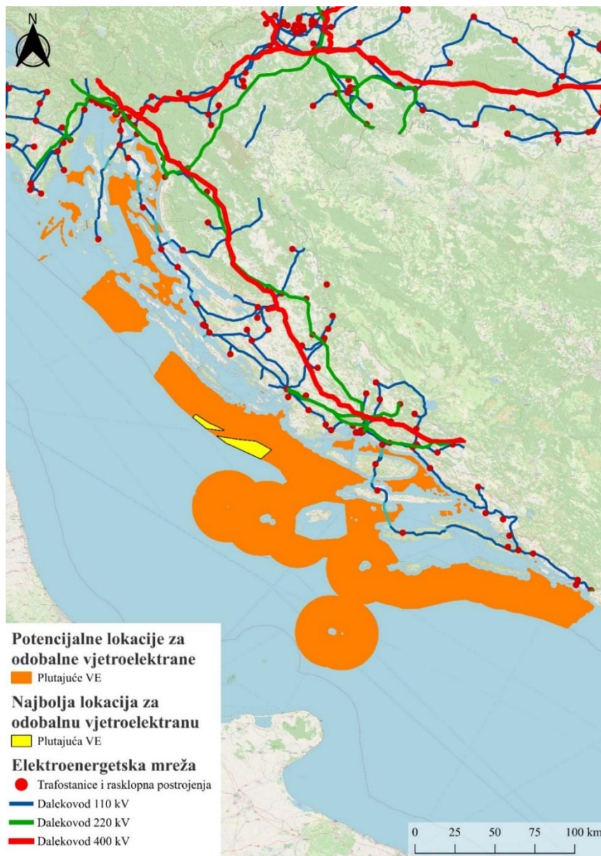
Slika 37. Najbolja lokacija za izgradnju plutajuće odobalne vjetroelektrane u Hrvatskoj
