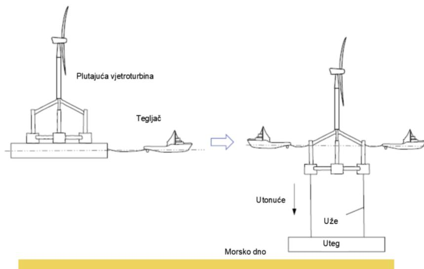
**Slika 47. Princip instalacije plutajuće odoabalne vjetroturbine (platforma na više stupova) [22]**
