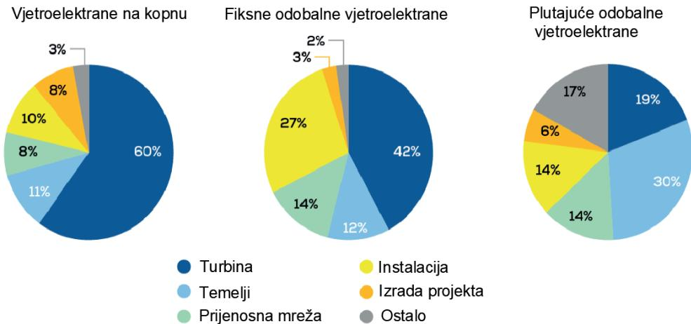
Slika 51. Analiza CAPEX-a za izgradnju vjetroelektrane [10]
