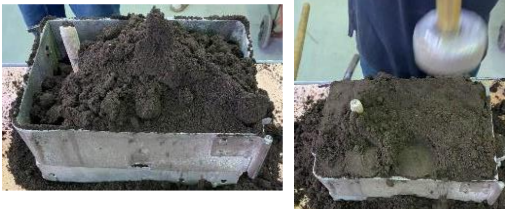
Slika 59. Nasipavanje kalupne mješavine i sabijanje
