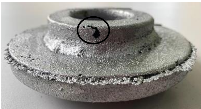
Slika 73. Poroznost na odljevku
