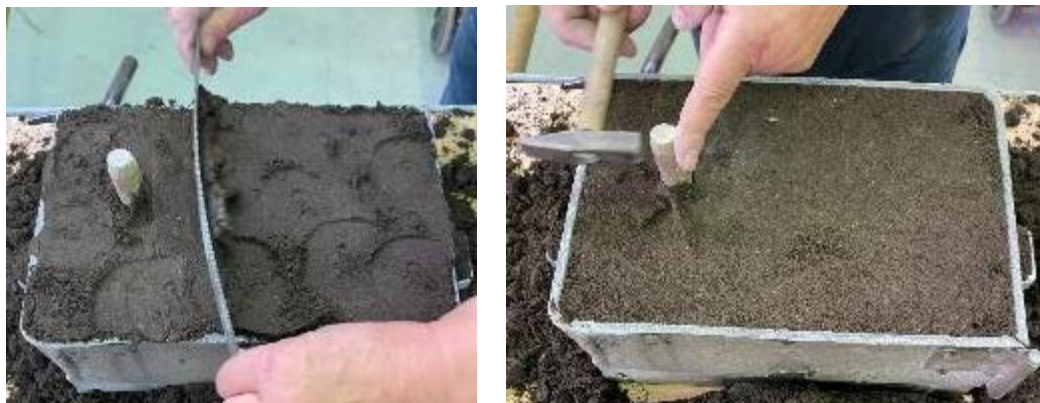
Slika 60. Uklanjanje viška kalupne mješavine i vađenje spusta
