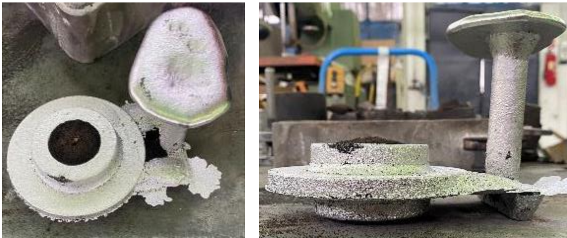
Slika 71. Odljevak s uljevnim sustavom
