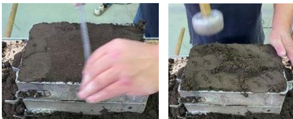
Slika 63. Sabijanje i uklanjanje viška kalupne mješavine
