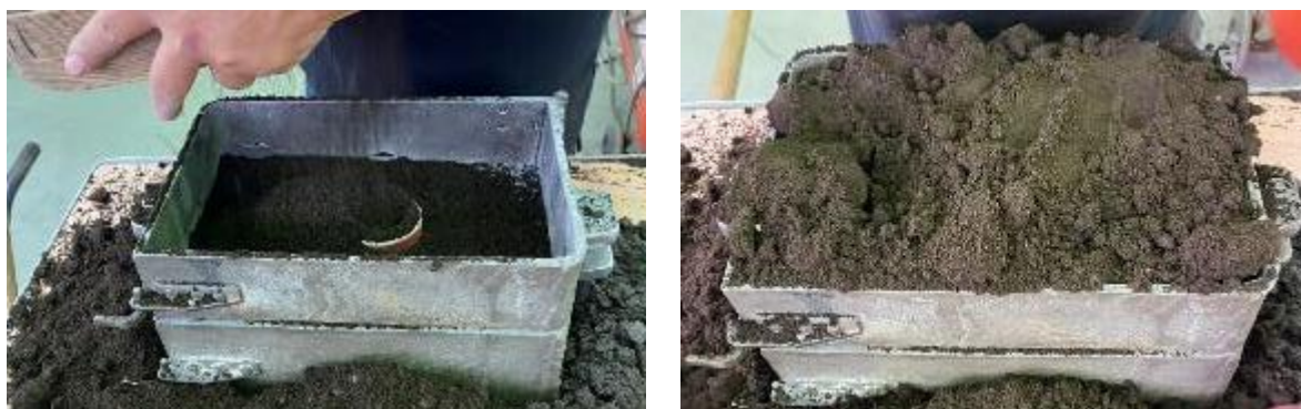
Slika 62. Nasipavanje modelne i punidbene kalupne mješavine
