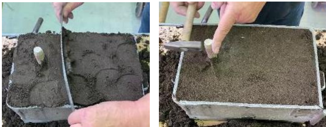
Slika 60. Uklanjanje viška kalupne mješavine i vađenje spusta
