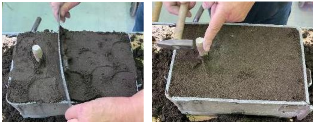
Slika 60. Uklanjanje viška kalupne mješavine i vađenje spusta
