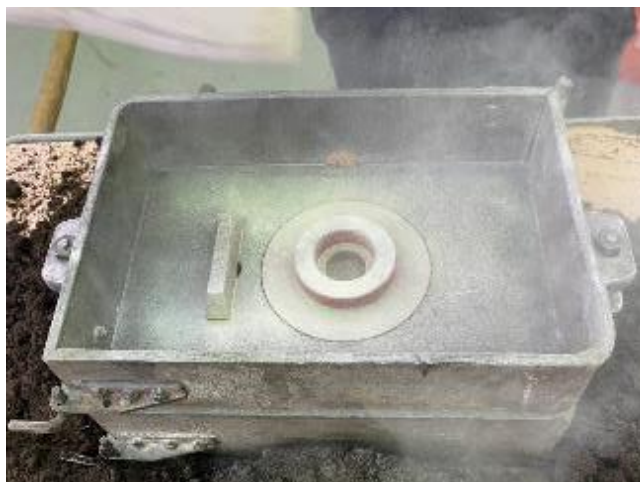
Slika 61. Postavljanje donjeg dijela kalupa i modela razvodnika
