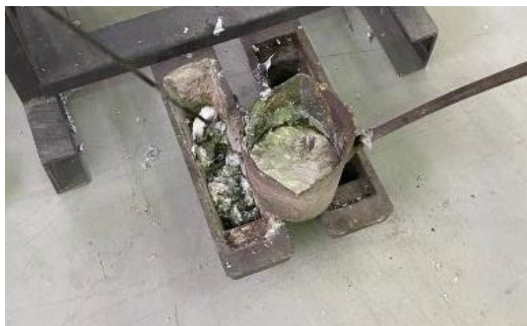
Slika 68. Uklanjanje sloja oksida sa površine taljevine
