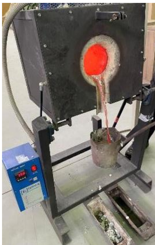
Slika 67. Izlivanje taljevine u lonac
