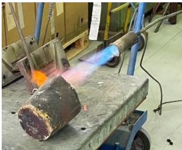
Slika 65. Zagrijavanje lonca plinskim plamenom
