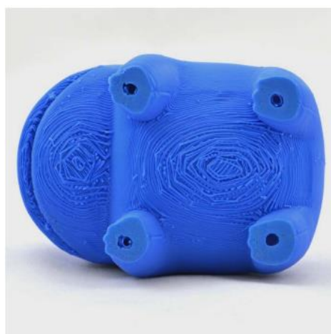
Slika 25. Oštećenja površine ispod potporne strukture [2]
