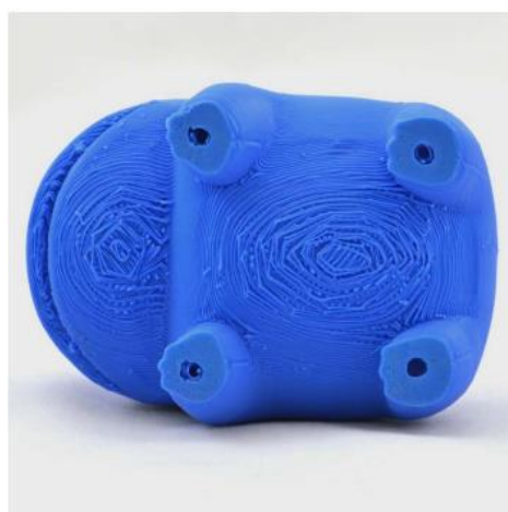
Slika 25. Oštećenja površine ispod potporne strukture [2]
