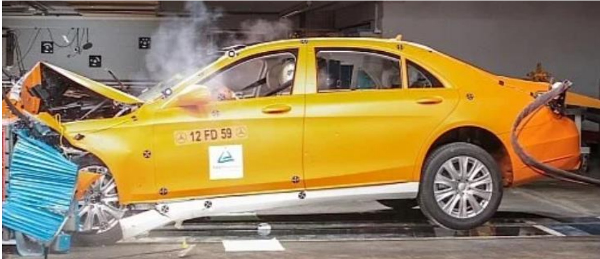
Slika 30. Frontalni sudar i oštećenje prednjeg dijela vozila [18]
