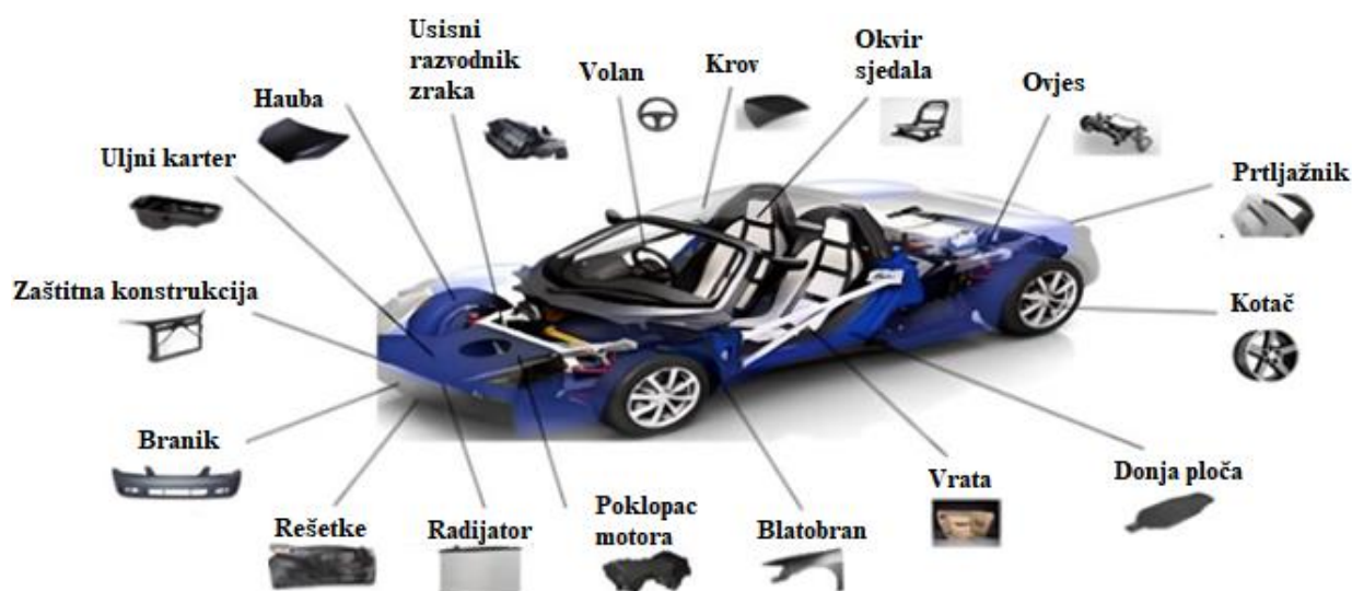
Slika 4. Kompozitni dijelovi automobila [6]
