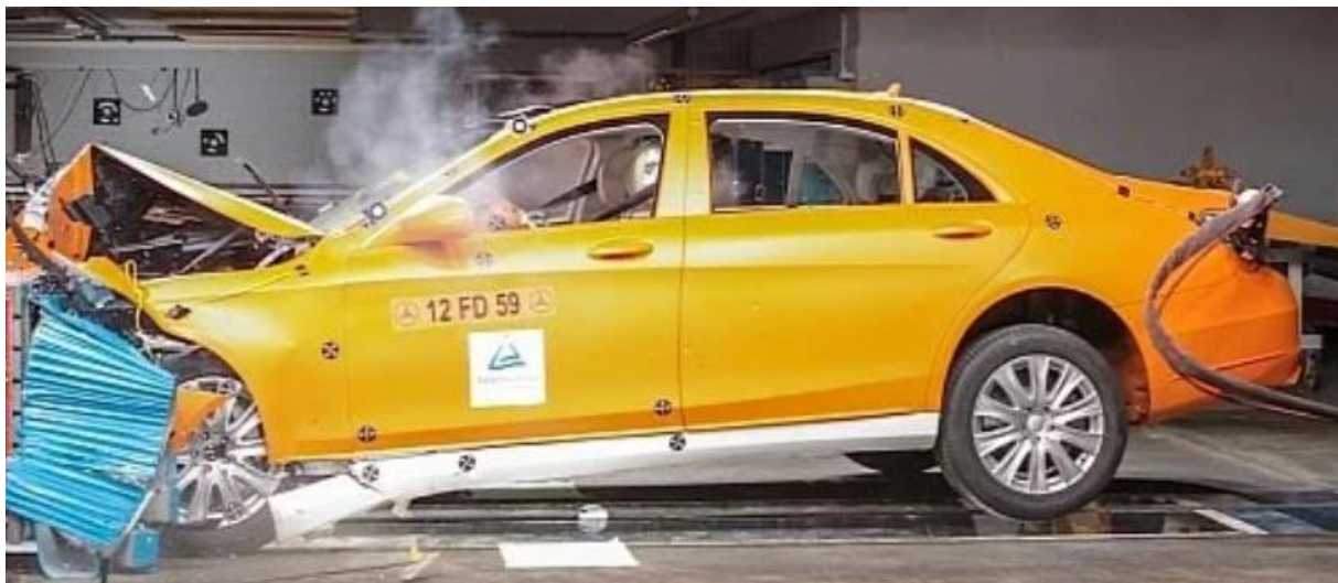
Slika 30. Frontalni sudar i oštećenje prednjeg dijela vozila [18]
