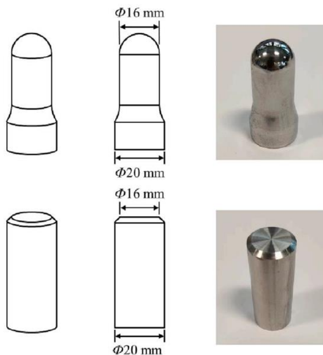
Slika 12. Geometrija udarnih tijela [15]
