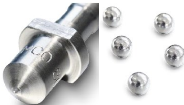
Slika 11. Indentori za Rockwell metodu [20]
