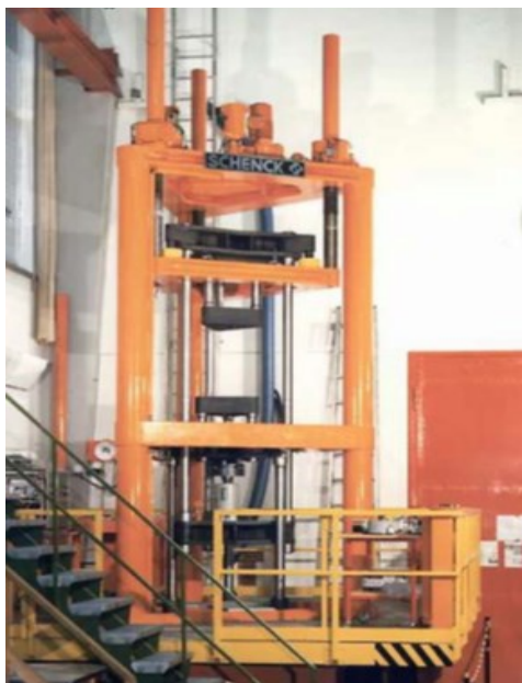
Slika 13. Primarni nacionalni etalon sile u PTB-u, Njemačka [2]
