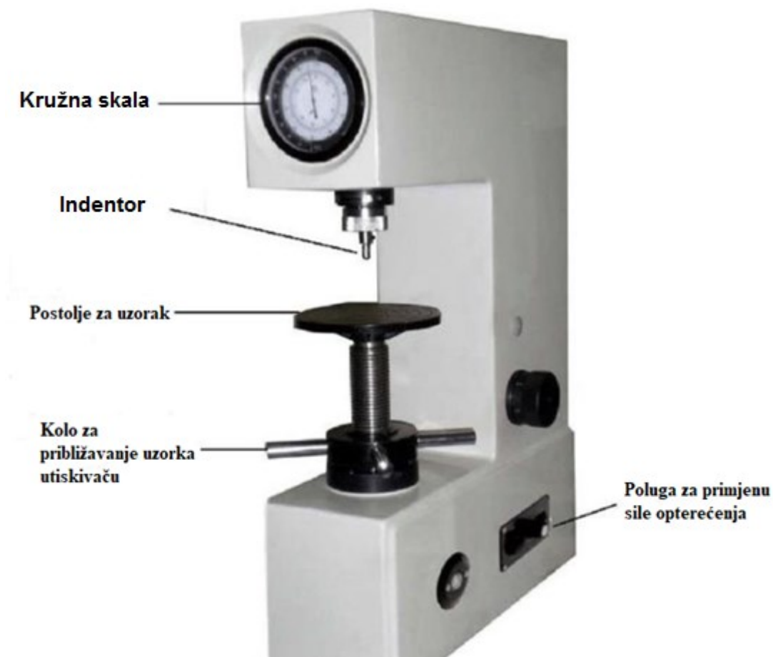
Slika 8. Tvrdomjer za Rockwell metodu [13]
