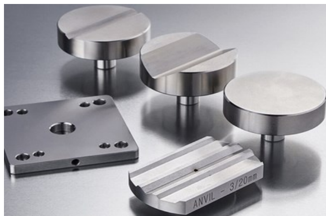
Slika 10. Vrste postolja za ispitne uzorke [20]
