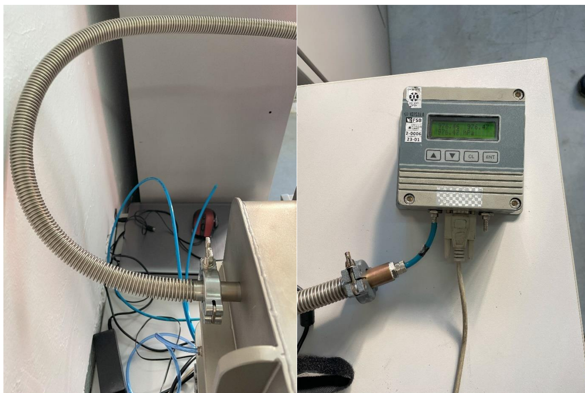
Slika 24. Etalonski barometar Vaisala (desno) i izvedba spoja na komoru (lijevo)
