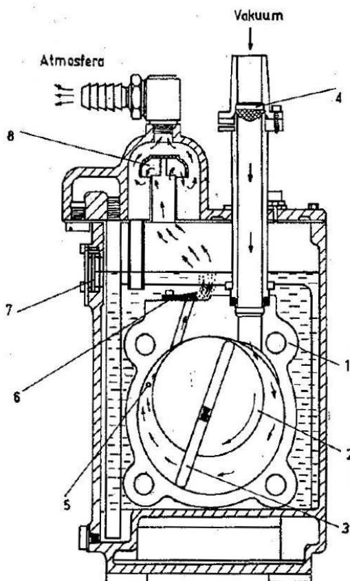
*Slika 16. Presjek jednostupanjske rotorske vakuum pumpe s krilcima*
