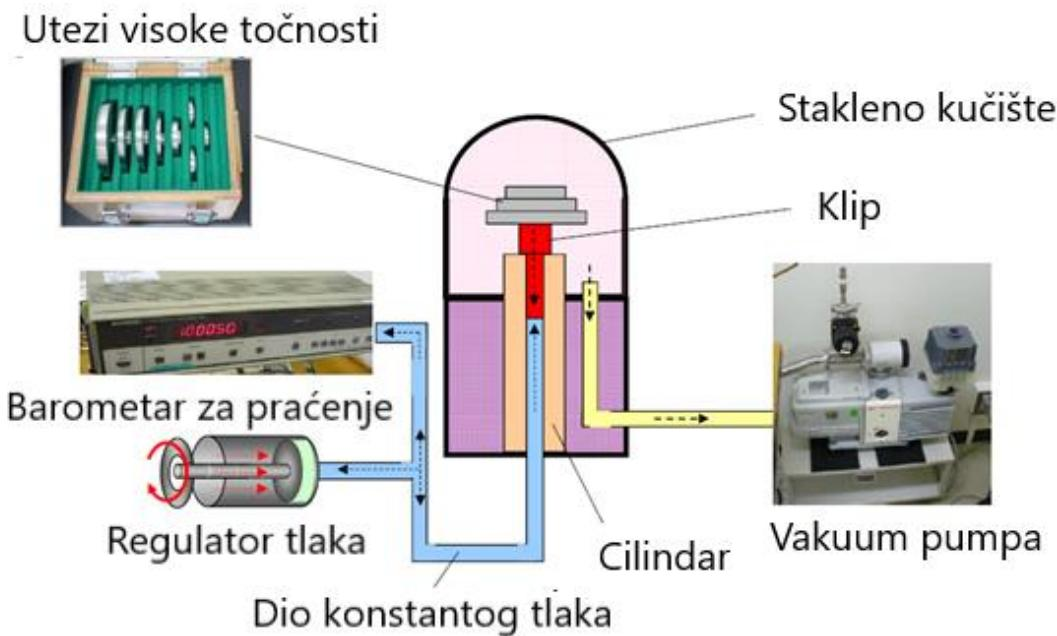
*Slika 13. Princip rada absolutne tlačne vase*
