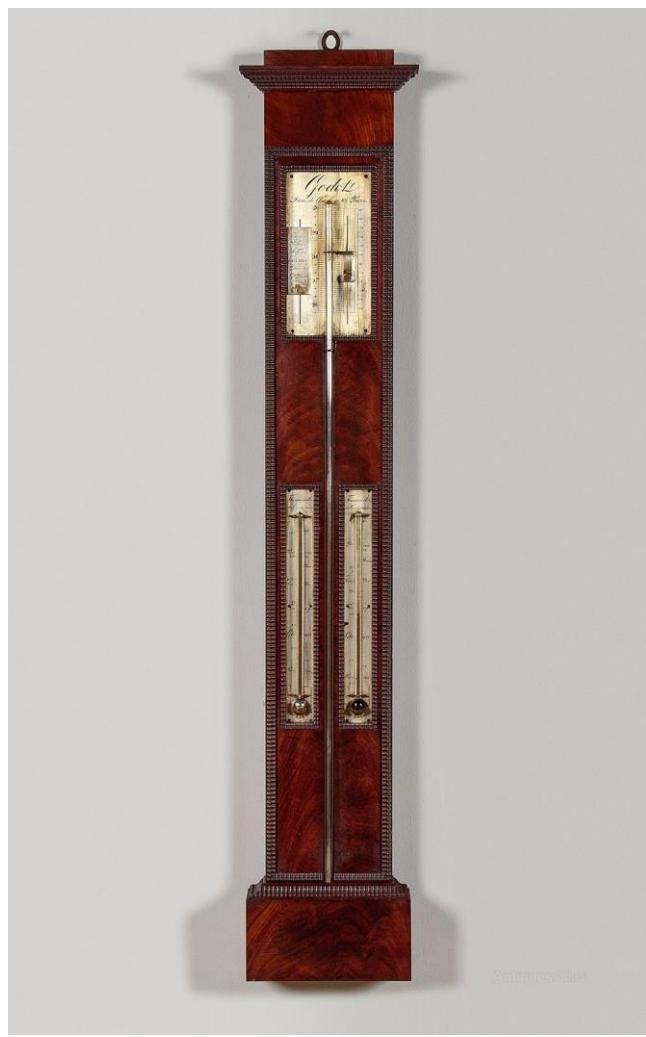
Slika 5. Živin barometar u drvenom kućištu
