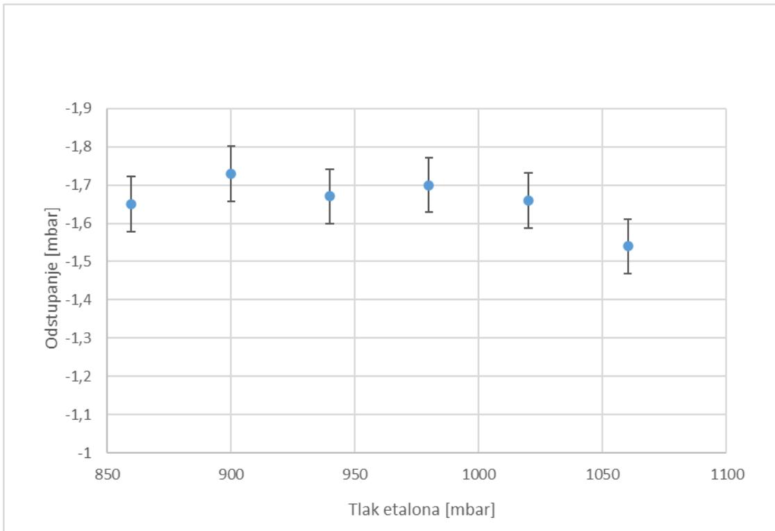
Slika 27. Ovisnost odstupanja i mjernih nesigurnosti o etalonskom tlaku - TEOKO9
