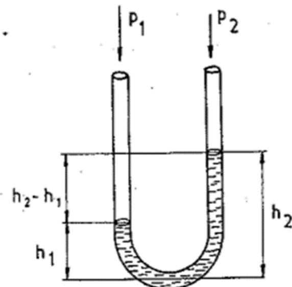
*Slika 6. Manometar s U-cijevi*
