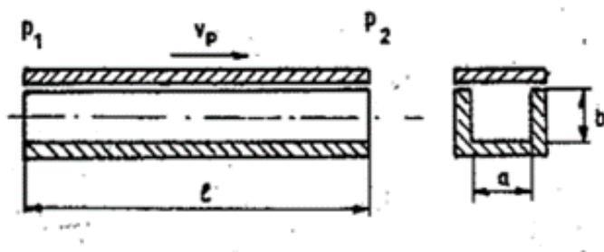
**Slika 18. Molekularno pumpanje pokretnim dijelom uskog kanala**
