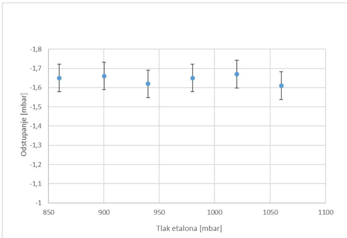
Slika 28. Ovisnost odstupanja i mjernih nesigurnosti o etalonskom tlaku - TEOKO10
