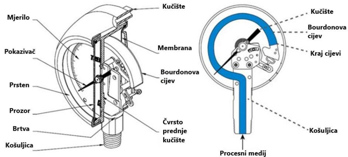
*Slika 8. Manometar s elastičnom šupljom cijevi - Bourdonova cijev*
