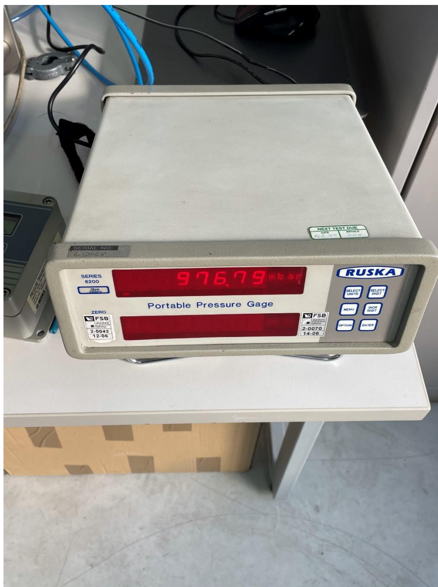
Slika 12. Digitalni barometar Ruska 6200 u vlasništvu LPM-a
