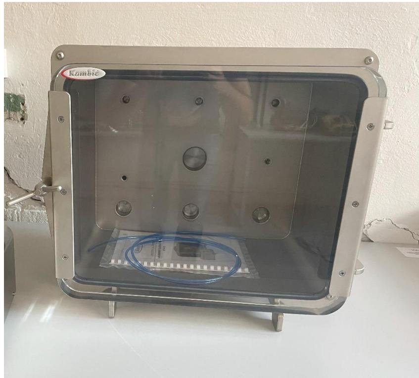
**Slika 22. Vakuumsko tlačna komora slovenskog proizvođača Kambič**
