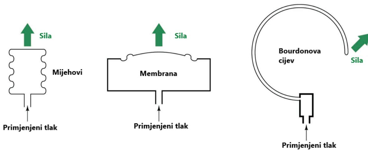
*Slika 7. Elastični elementi mjerila s mehaničkom deformacijom*
