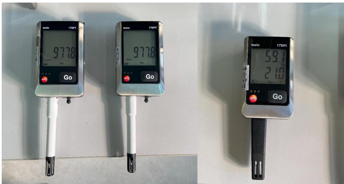
Slika 25. Ispitivani barometri marke Testo 176P1(ljevo) i uređaj za mjerjenje temperature i vлаге zraka Testo 175H1(desno)
