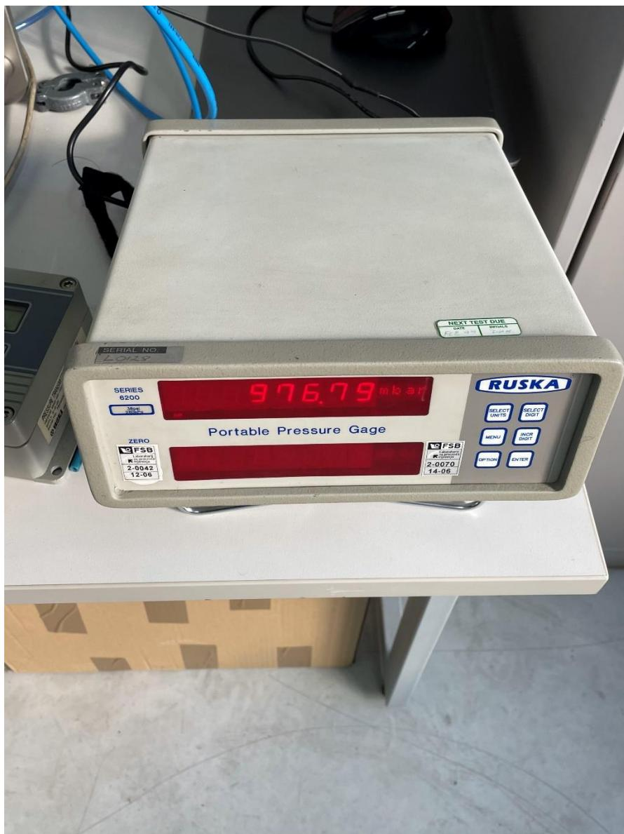
Slika 12. Digitalni barometar Ruska 6200 u vlasništvu LPM-a
