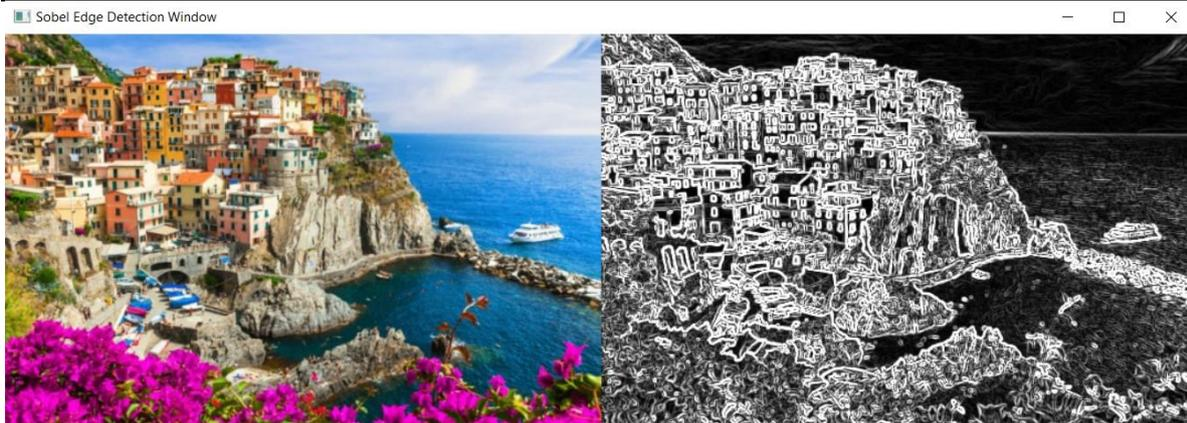
Slika 47. Sobelov operator za detekciju rubova [30]
