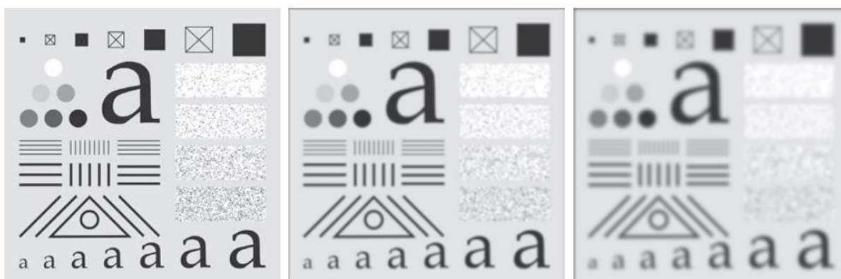
Slika 14. Utjecaj Gaussian filtera na sliku [2]
