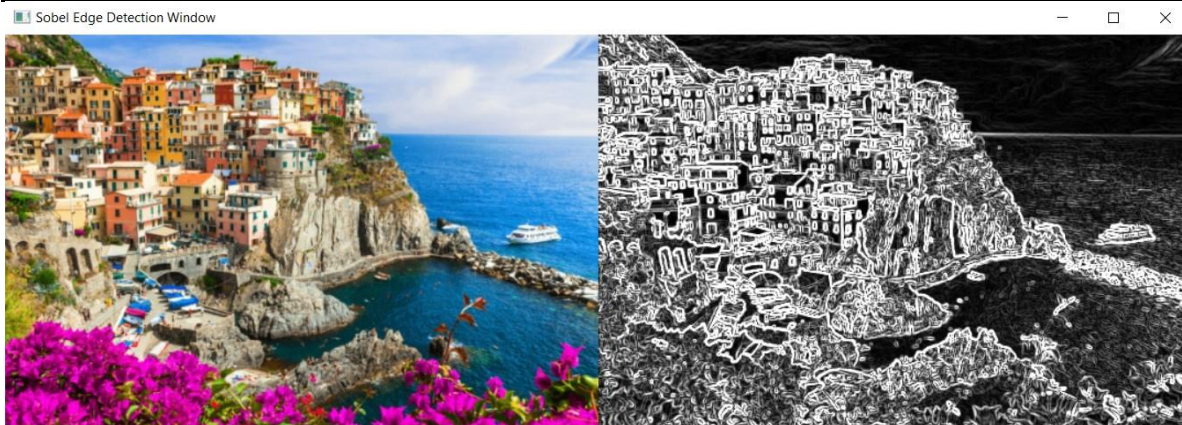
Slika 47. Sobelov operator za detekciju rubova [30]
