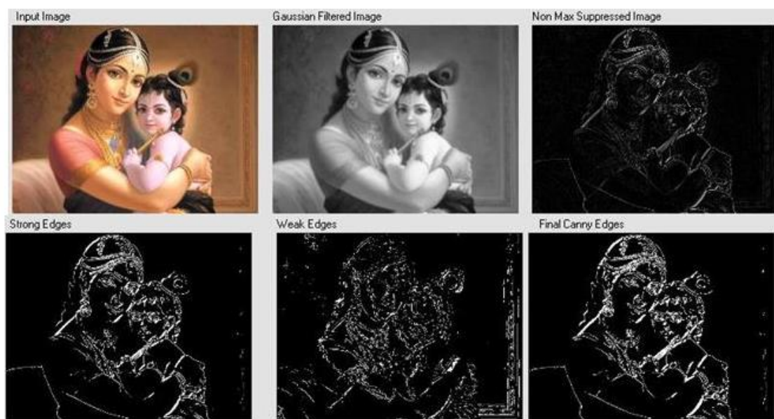
Slika 30. Primjer Canny edge detektora na slici [18]
