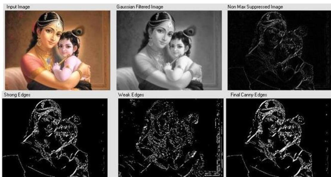
**Slika 30. Primjer Canny edge detektora na slici [18]**
