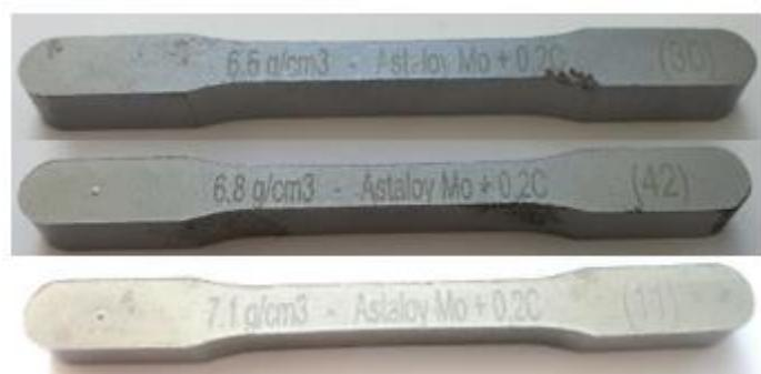
**Slika 5.1. Ispitni uzorci materijala Astaloy Mo+0,2C gustoća  $6,5 \text{ g/cm}^3$ ,  $6,8 \text{ g/cm}^3$  i  $7,1 \text{ g/cm}^3$**
