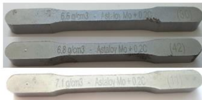
Slika 5.1. Ispitni uzorci materijala Astaloy Mo+0,2C gustoća 6,5 \text{ g/cm}^3 , 6,8 \text{ g/cm}^3 i 7,1 \text{ g/cm}^3 Geometrija ispitnih uzoraka je napravljena prema dimenzijama prikazanim na slici 5.2.
