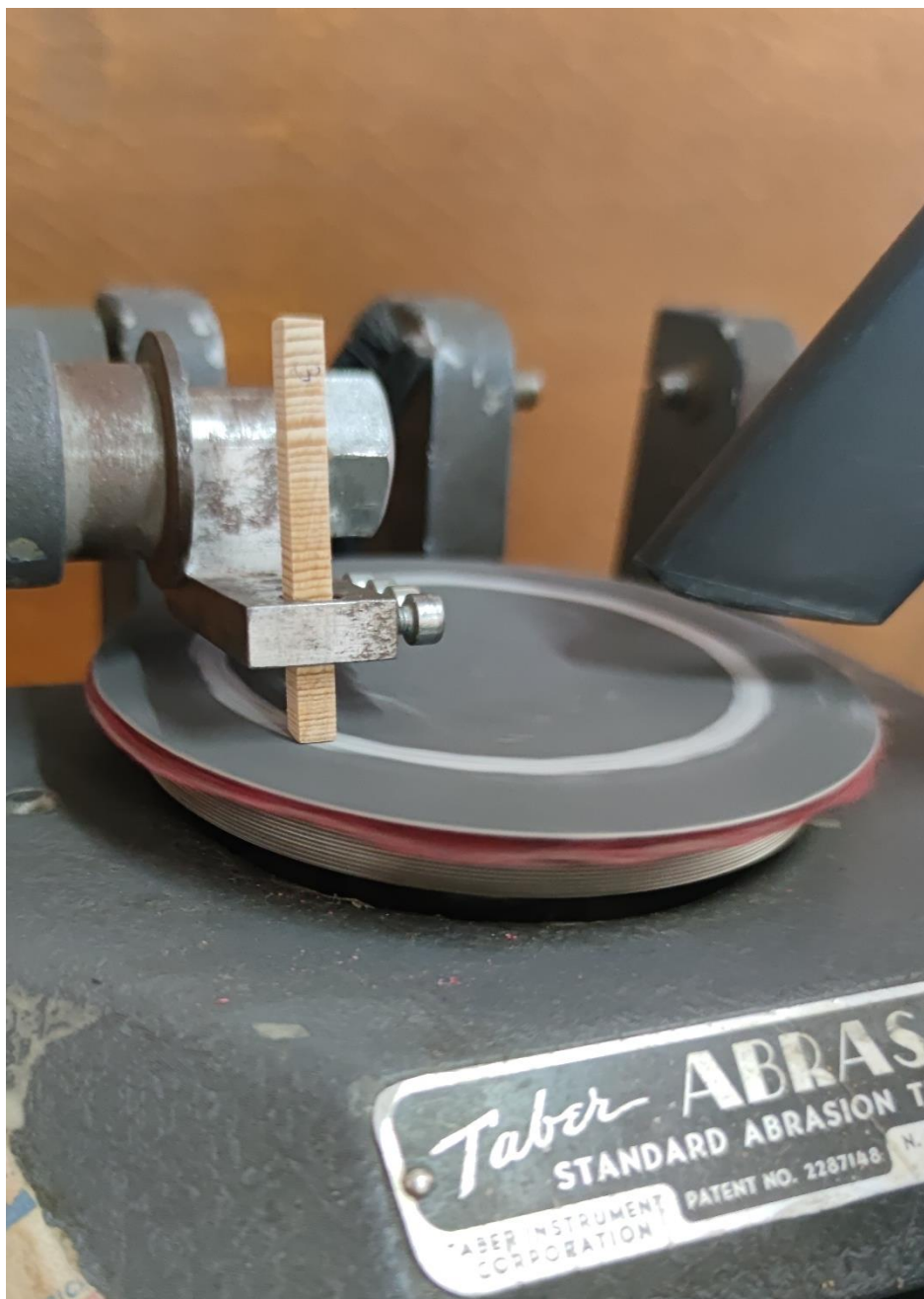
Slika 29. Ispitivanje abrazijske otpornosti na uređaju Taber abrader
