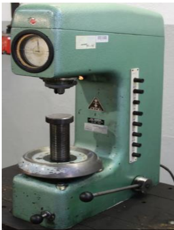
Slika 31. Tvrdomjer VEB WPM HP 250 [24]
