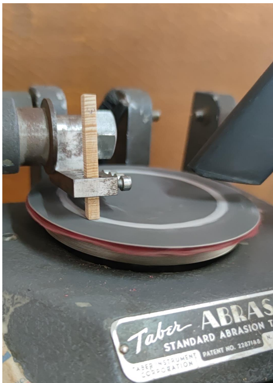
Slika 29. Ispitivanje abrazijske otpornosti na uređaju Taber abrader
