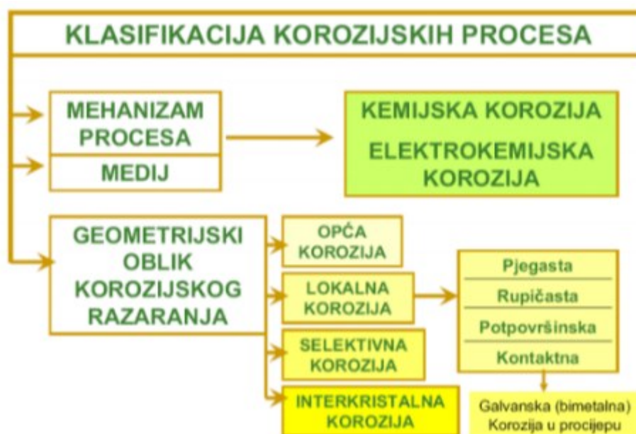
Slika 20. Klasifikacija korozijskih procesa [45]
