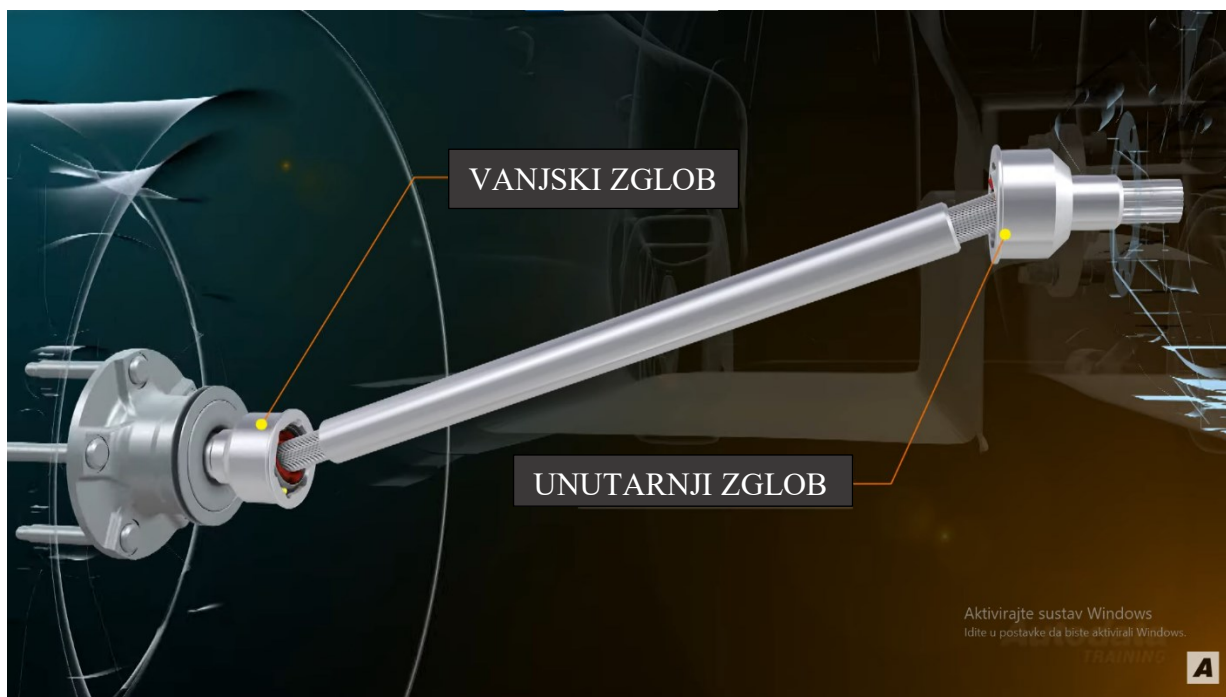
Slika 11. Prikaz lokacije unutarnjeg i vanjskog CV zgloba [17]
