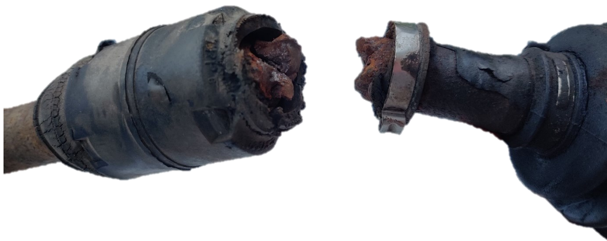
Slika 27. Mjesto loma pogonskog vratila s homokinetičkim zglobom
