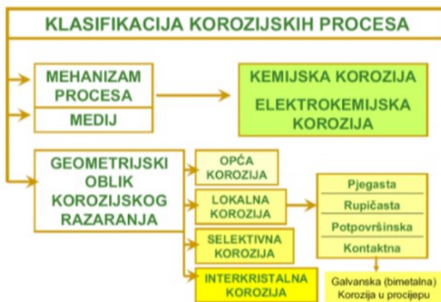
Slika 20. Klasifikacija korozijskih procesa [45]
