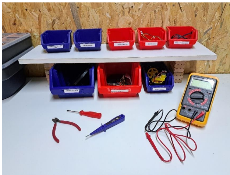
Slika 53. Sortiranje komponenti i alata korištenjem 5S-a
