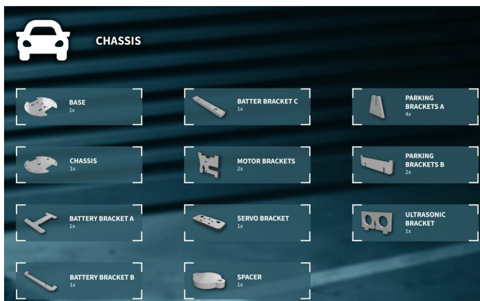
Slika 34. Dijelovi šasije robotskog vozila[30]
