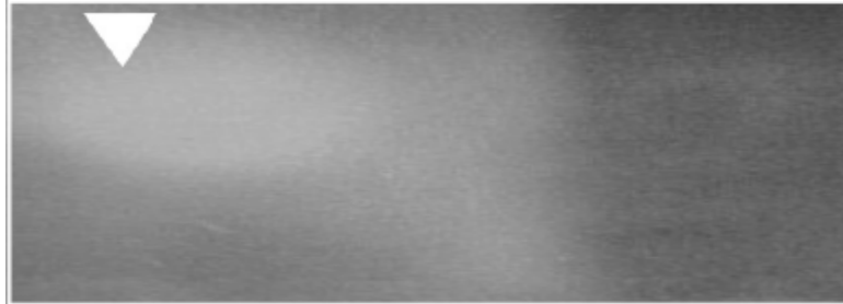
Slika 14: Greška na filmu uzrokovana pritiskom
