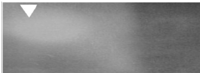
Slika 14: Greška na filmu uzrokovana pritiskom
