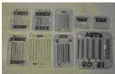
Slika 7: Indikatori kvalitete radiograma
