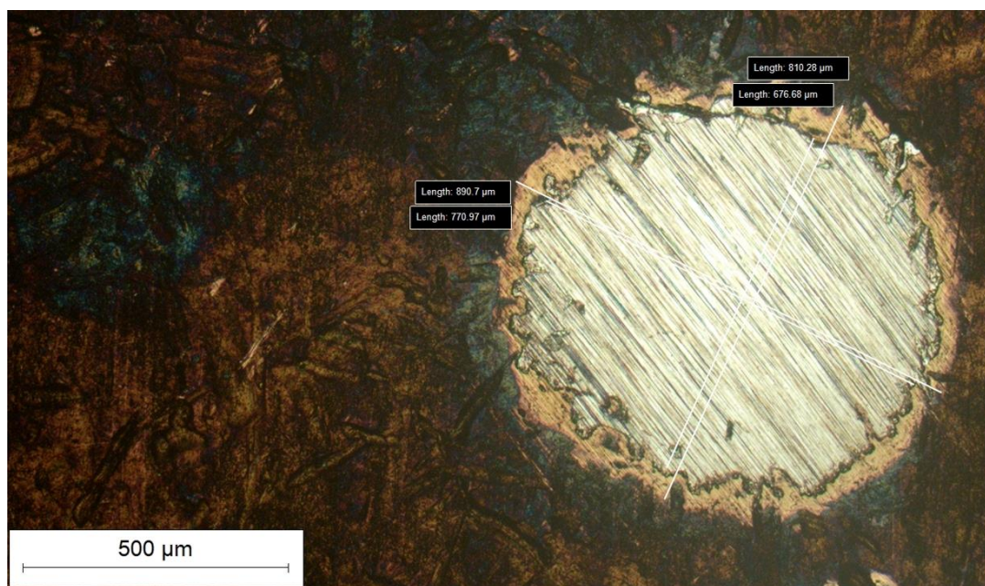
Slika 57 1. i 2. mjerenje promjera za određivanje debljine prevlake kod uzorka C (540 °C, 6 h)
