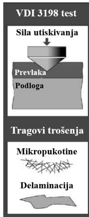
Slika 45 Metoda ispitivanja prionljivosti prevlake prema normi VDI 3198:2003 [42]
