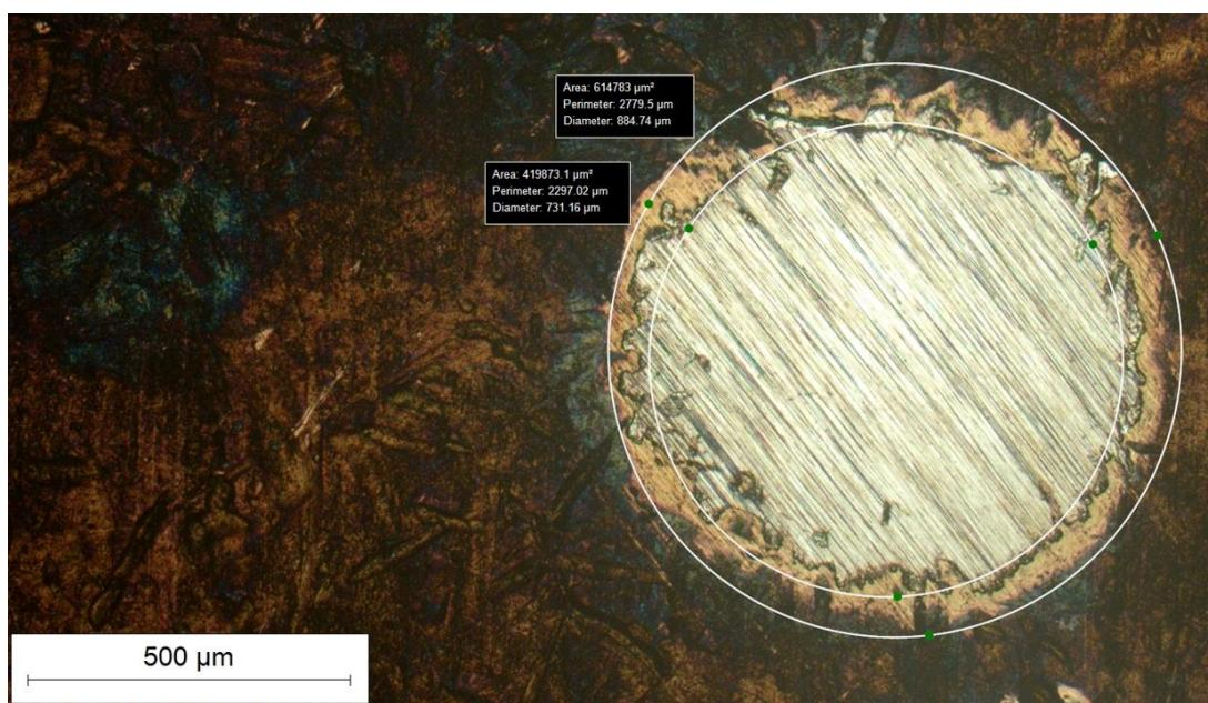
Slika 58 3. mjerjenje promjera za određivanje debljine prevlake kod uzorka C (540 °C, 6 h)
