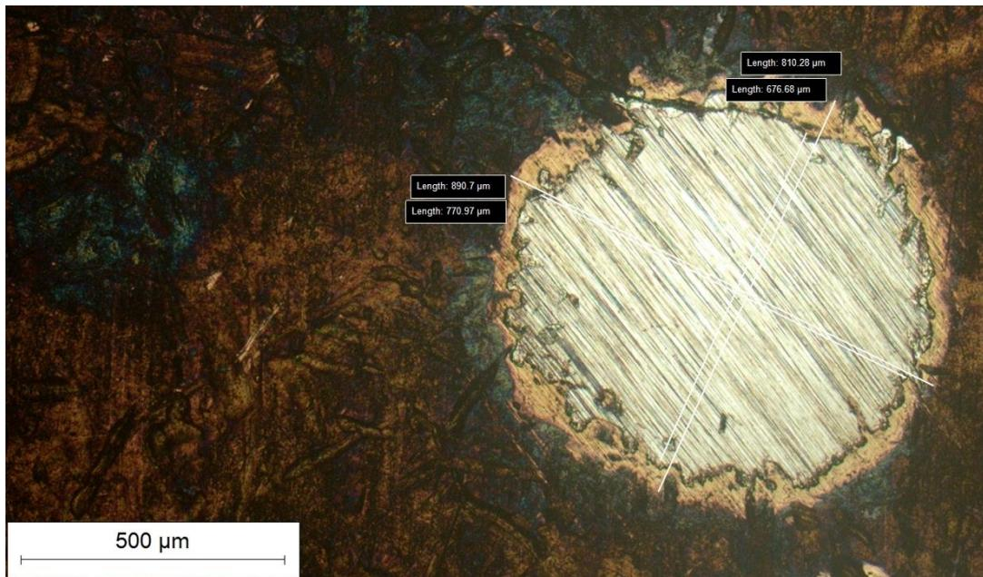
Slika 57 1. i 2. mjerjenje promjera za određivanje debljine prevlake kod uzorka C (540 °C, 6 h)
