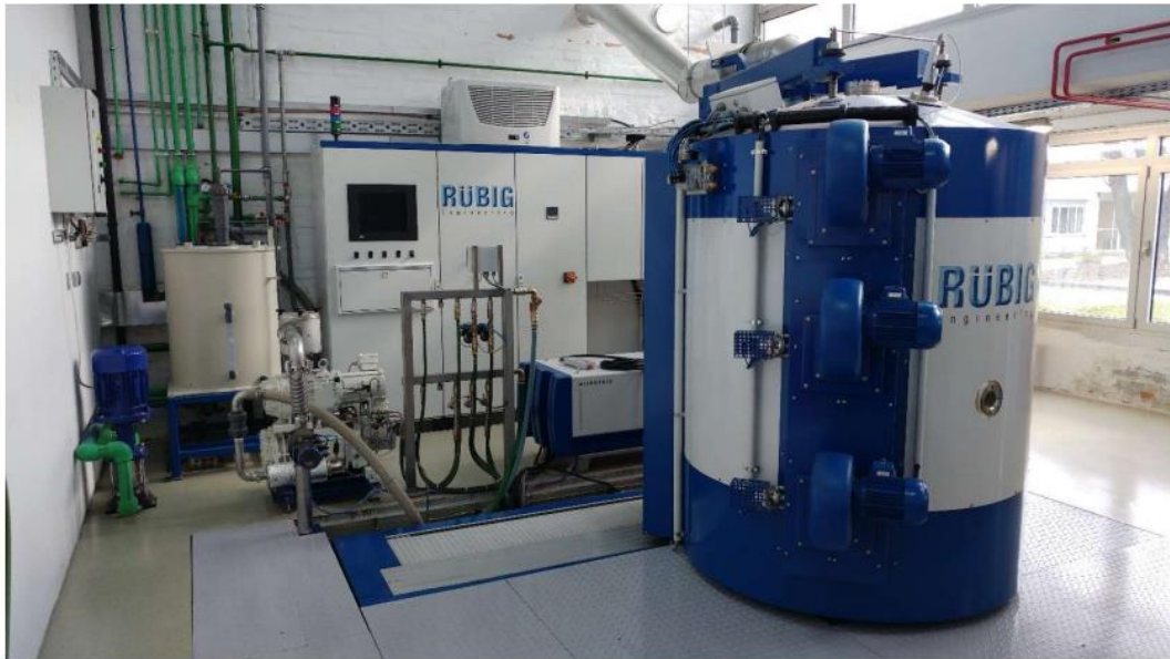
Slika 40 PACVD uređaj RÜBIG GmbH Type PC 70/90 na FSB-u [41]
