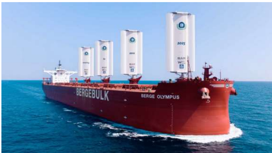
Slika 1. Primjer tehničkog rješenja za vjetrom potpomognutu propulziju broda za rasuti teret [3].
