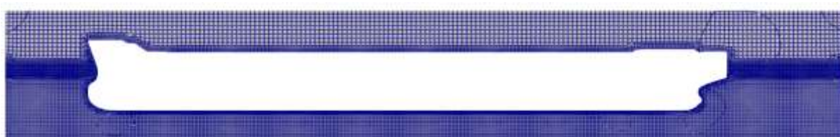
Slika 7. Diskretizirana domena, uzdužni presjek broda.
